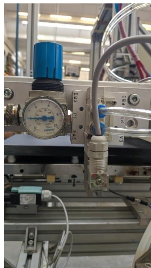
Figura 40: Regolatore di pressione dei cilindri del rullo
