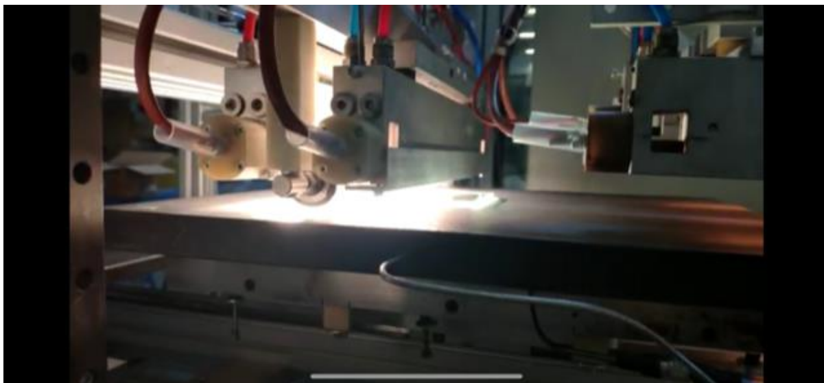
Figura 36: La piastra di ferro si sposta sotto il rullo che applica una pressione sul vetro e allo stesso tempo riscalda mediante le lampade a infrarosso.
