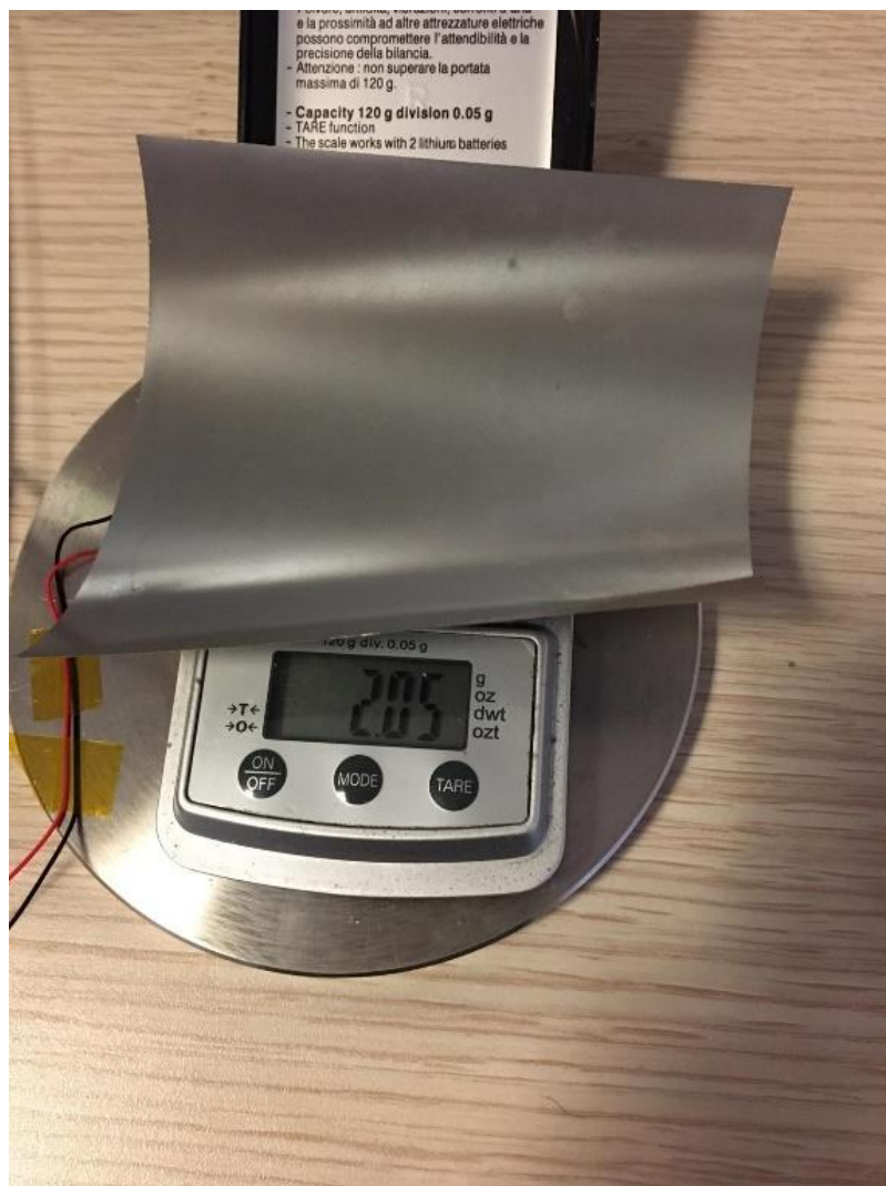
Figura 43: Peso della lastra di nickel per verifica spessore lastra.
