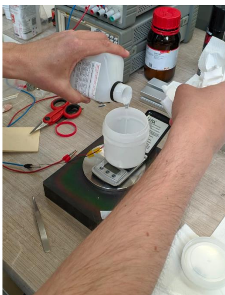
Figura 14: Riempimento del container speciale del mixer con silicone e nanoparticelle
