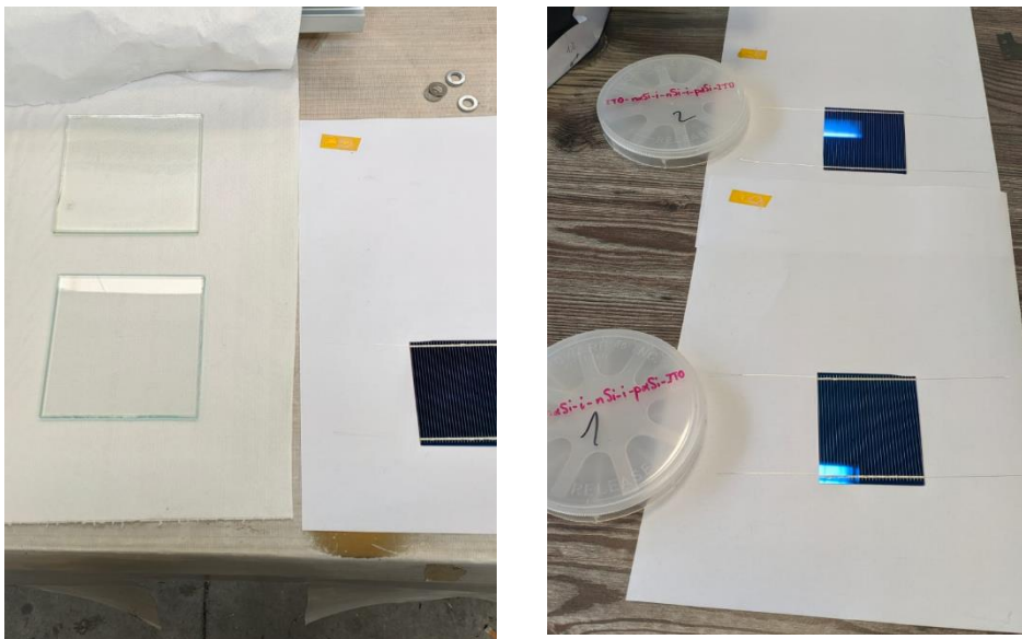
Figura 15: sinistra, vetri back side; destra, celle solari a cui sono stati incollati mediante ECA i ribbon frontali e posteriori
