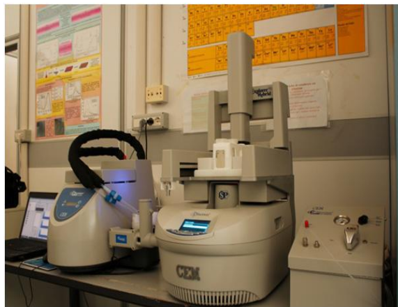
Figura 5. Reattore a microonde presso il Centro ENEA di Brindisi, dotato anche degli accessori per l'esecuzione di reazioni a T sub-ambiente e l'uso di reagenti gassosi.
