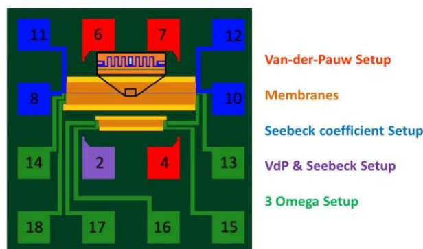
Figura 23. a) Vista frontale del chip pre-strutturato per TFA funzionale alla misura in configurazione Van der Pauw con indicazioni di massima delle aree di contatto usate per ciascuna misura. Immagine tratta dal manuale del macchinario
