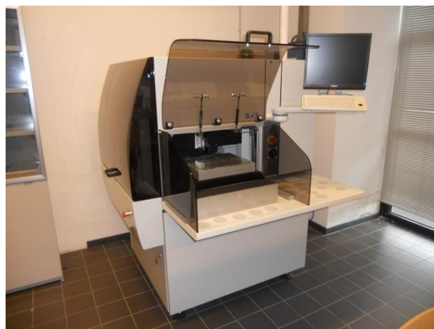
Figura 7. Apparecchiatura di stampa serigrafica
