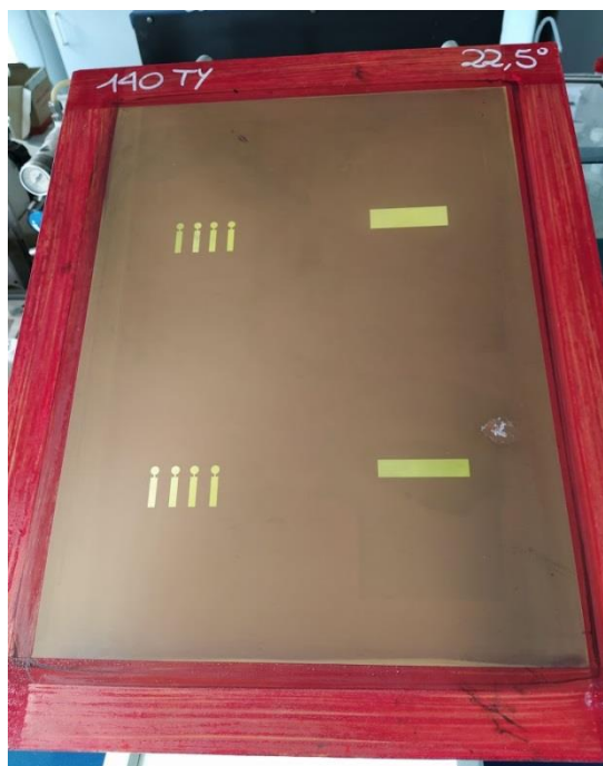
Figura 13: Telaio utilizzato per stampare i film di PEDOT con viscosità 25 mPa.s
