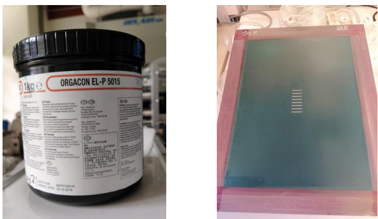
Figura 18: Pasta serigrafica AGFA e nuovo telaio
