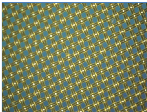
Figura 9. Tessuto del telaio serigrafico
