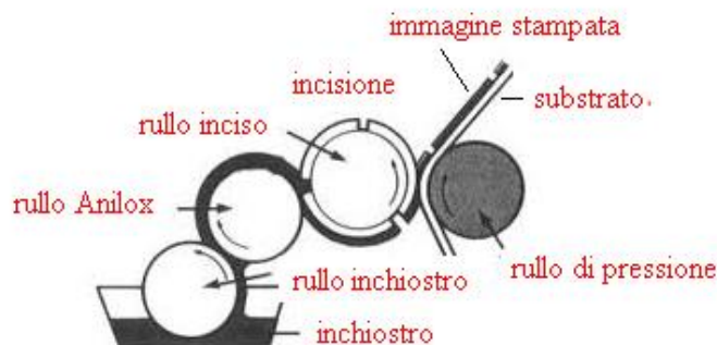
Figura 7. Stampa per flessografia: schema di principio.
