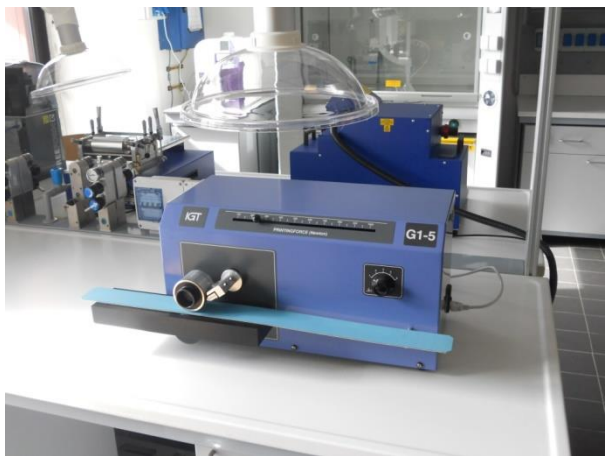
Figura 10. Apparecchiatura di stampa rotocalco (gravure printing)
