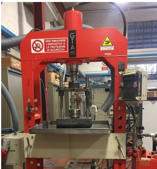
Figura 7. Pressa uniassiale e stampo per provini cilindrici disponibili presso i Laboratori ENEA di Faenza
