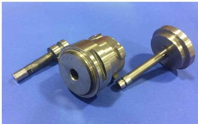
Figura 7. Pressa uniassiale e stampo per provini cilindrici disponibili presso i Laboratori ENEA di Faenza
