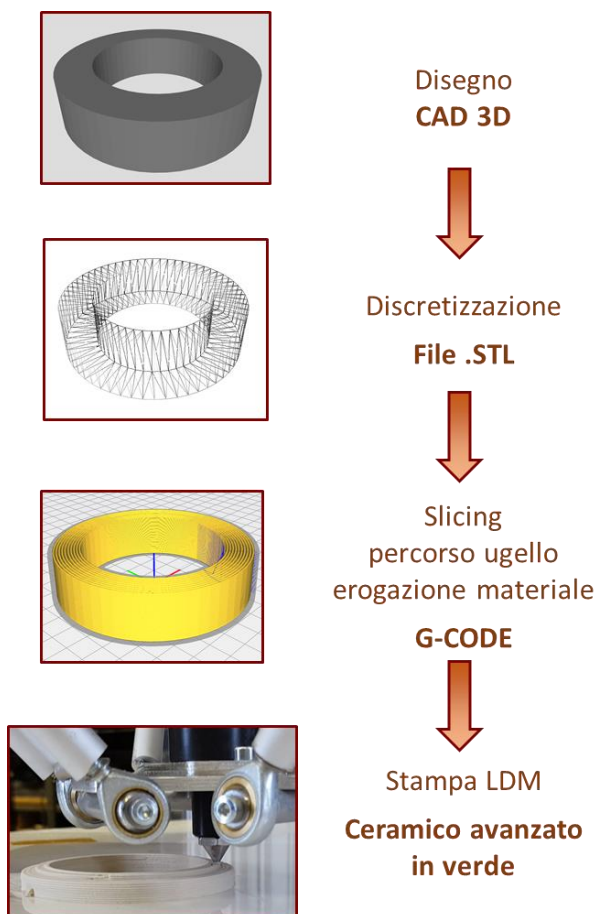
Figura 6. Schema tipico dei passaggi dal disegno 3D alla stampa LDM del ceramico avanzato con la stampante Delta WASP 40100 Clay installata presso il Laboratorio Tecnologie dei Materiali Faenza TEMAF dell'ENEA
