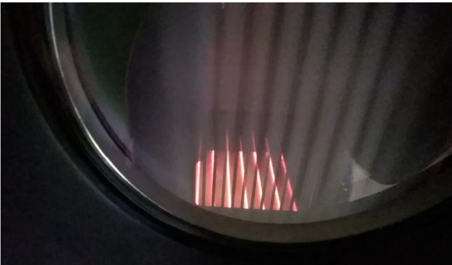
Figura 10: fase di preriscaldamento del letto di polvere durante la stampa di un componente in lega di titanio mediante EBM (Arcam A2X)
