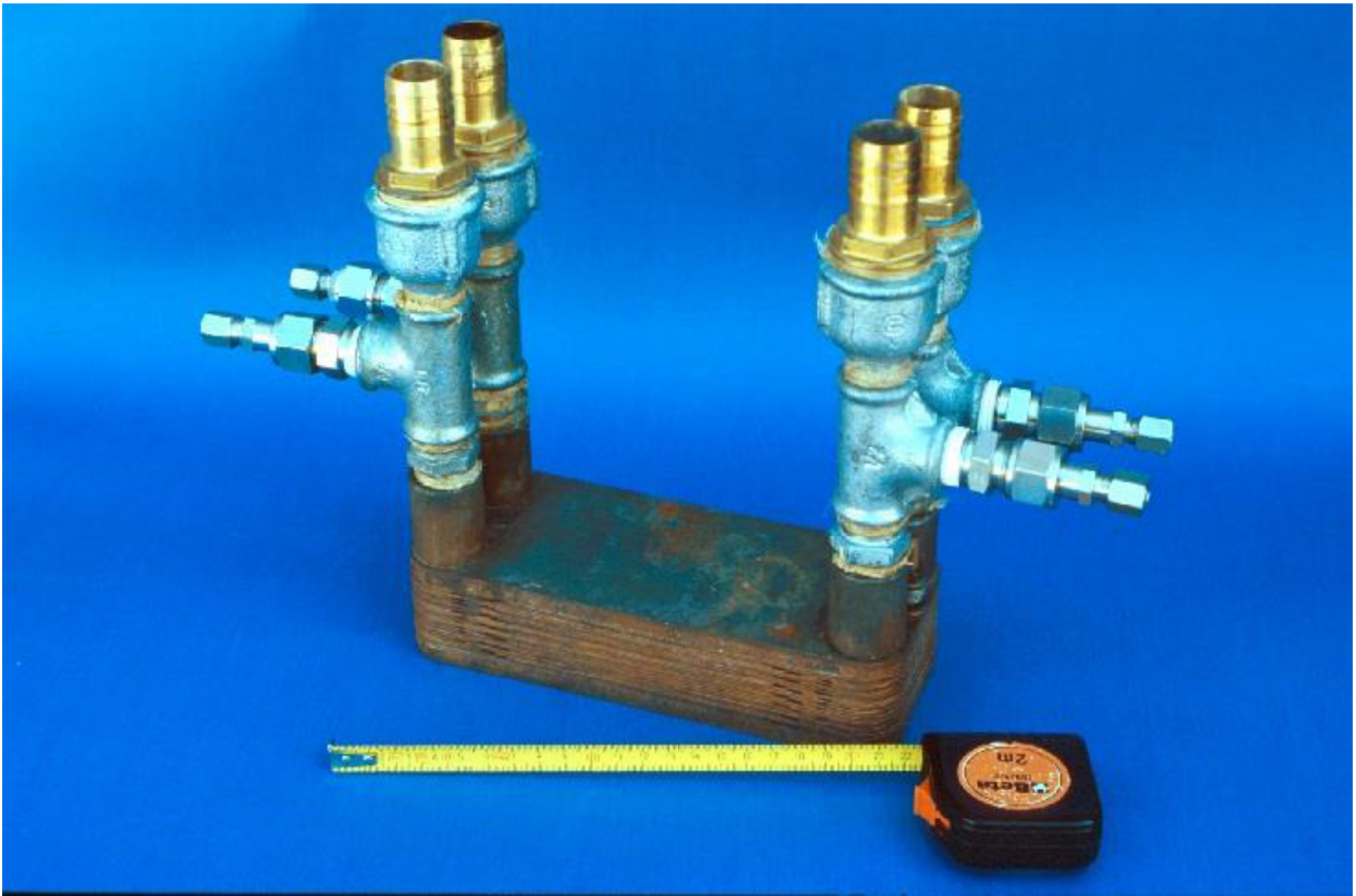
Figura 1: prototipo realizzato con piastre forate da 8 mm e brasato al rame
