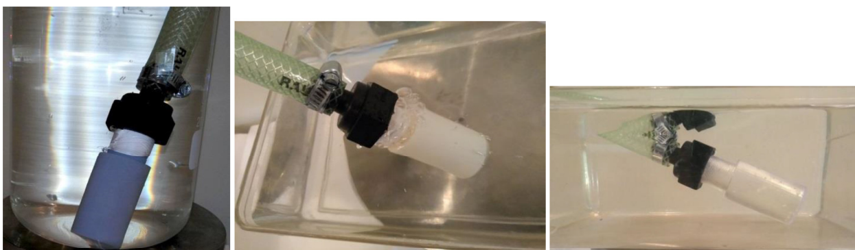
Figura 8: prove di tenuta in pressione dei tra campioni realizzati
