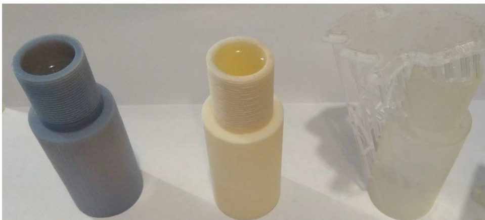
Figura 7: campioni realizzati per test di tenuta in pressione. Da sinistra a destra i campioni prodotti mediante binder jetting, FDM e SLA.
