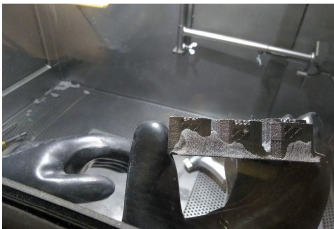
Figura 11: polvere sinterizzata su un componente realizzato mediante EBM
