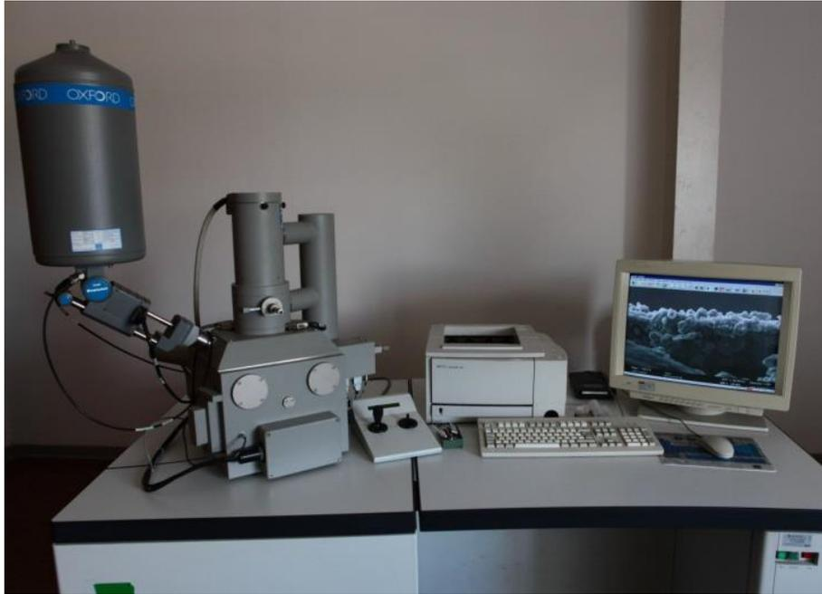
**Figura 10. Microscopio a Scansione Elettronica LEO 438-VP**
