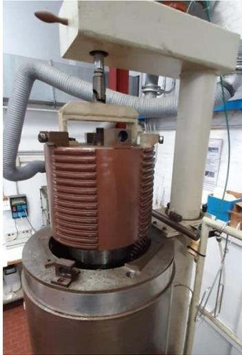
**Figura 5. Pressa isostatica a freddo HP28**
