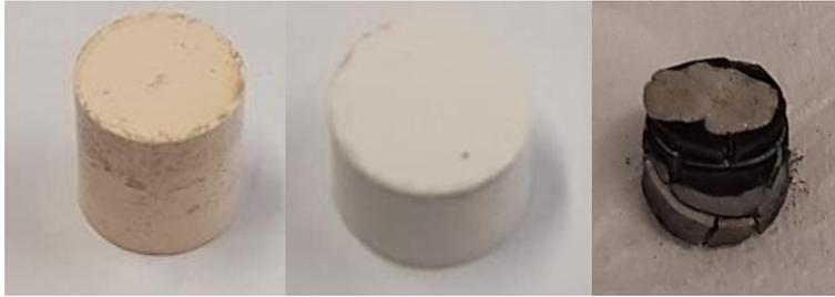
**Figura 11. Campioni verdi e sinterizzato di nanopolvere NL**
