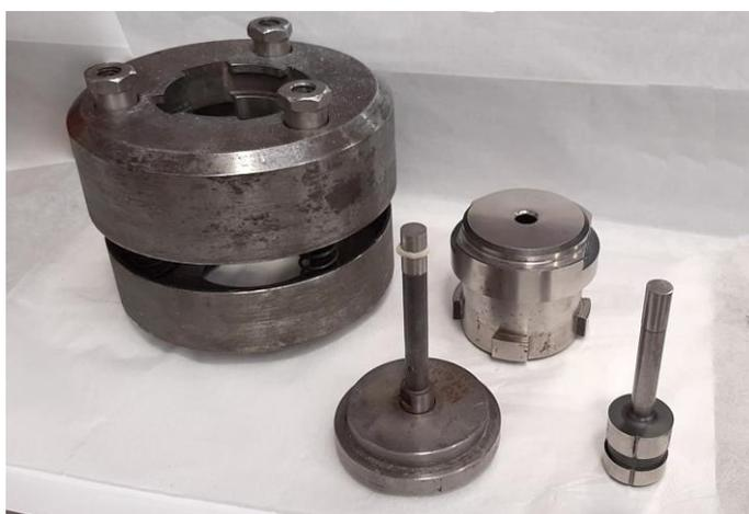
Figura 4. Stampo di acciaio per forme cilindriche e accessori della pressa uniaxiale
