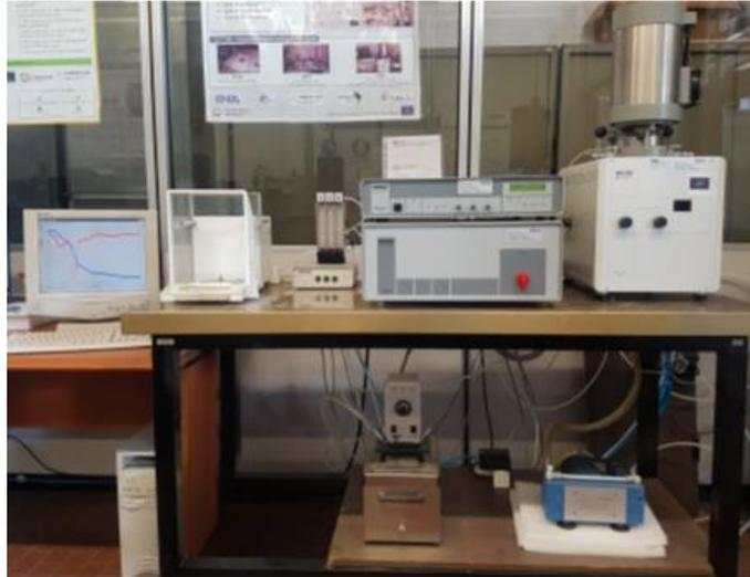
Figura 2. Analizzatore Termico DSC/TG STA 409 della NETZSCH
