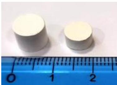
**Figura 9. Campioni di ZnS prima e dopo sinterizzazione: campione verde (a sinistra) e ceramico sinterizzato (a destra)**
