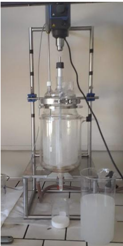
Figura 13. Reattore in vetro dell'impianto pilota in funzione
