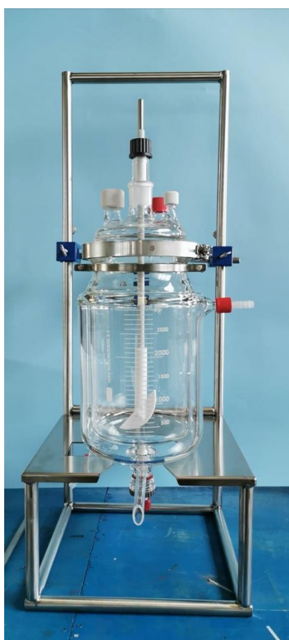
Figura 9. Reattore in vetro dell'impianto pilota
