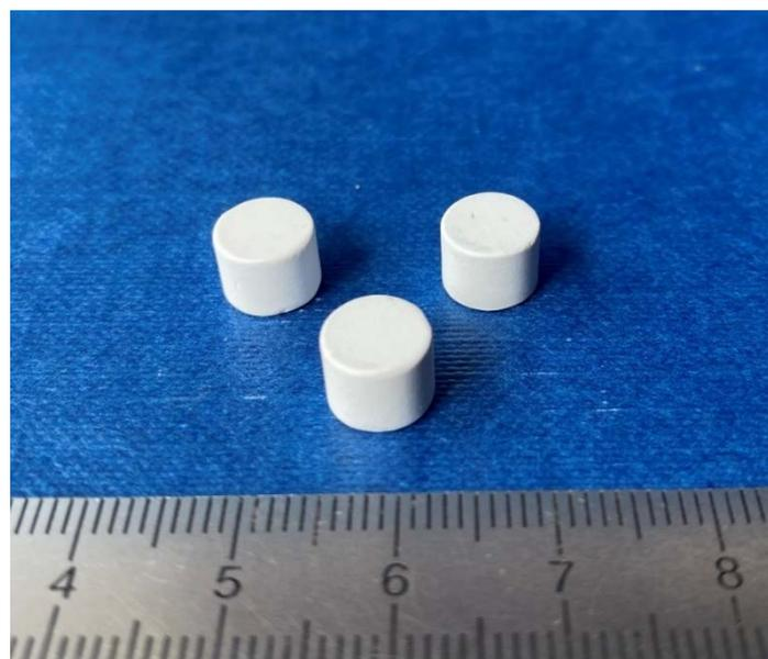
**Figura 6. Componenti ceramici verdi ottenuti compattando la polvere micrometrica di ZnS mediante pressa uniaassiale e poi isostatica a freddo.**
