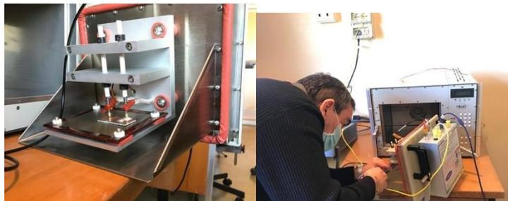
**Figura 5 Particolare della camera schermata**
