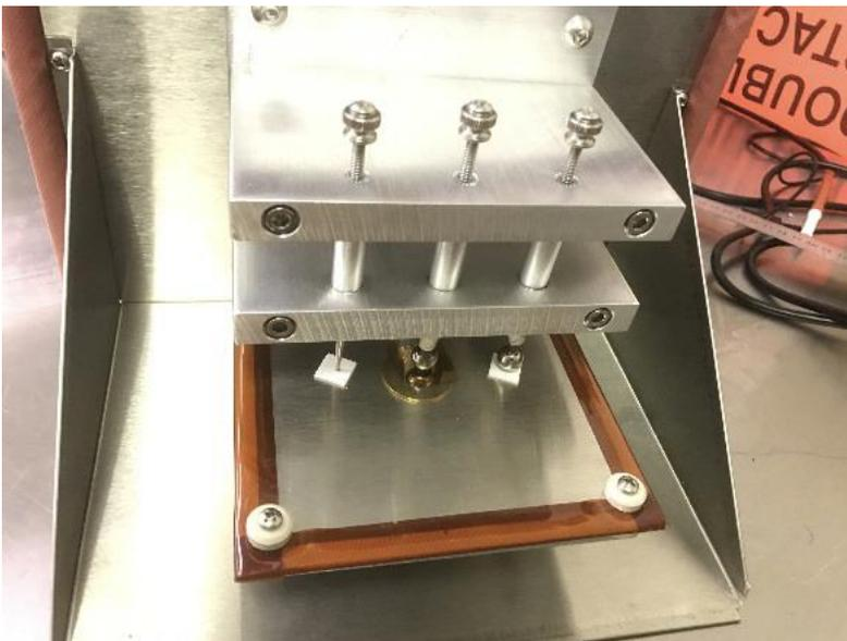
**Figura 3 Connessione elettrica con molla (Polyk PK-SPIV17T)**
