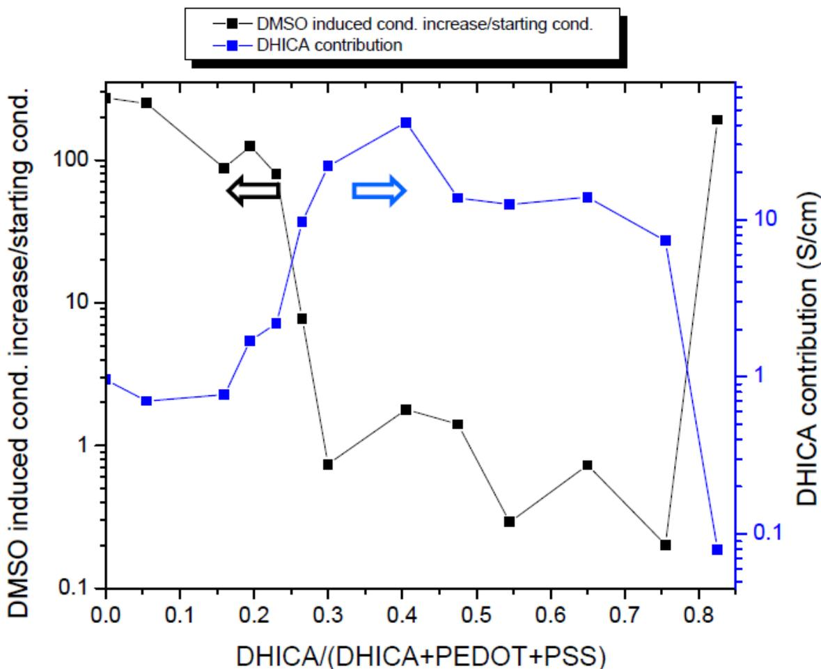
**Figura 3:** aumento di conduttività nel C-EuPH dopo il trattamento con DMSO (asse sinistro) e prodotto dell'aumento della conduttività e il rapporto delle conduttività prima e dopo il trattamento con DMSO ( $\Delta\text{Cond} \cdot \text{CondB}/\text{CondA}$ ).
