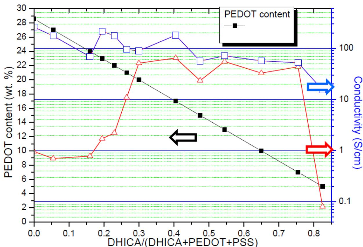
**Figura 2:** la conduttività elettrica dei film a vari contenuti di DHICA (peso del DHICA nelle frazioni DHICA/(PEDOT+PSS+DHICA): 0, 0,055, 0,160, 0,195, 0,230, 0,265, 0,300,0,405,0,475, 0,545, 0,650, 0,755, 0,825). I dati sono stati misurati prima (triangolo) e dopo (quadrato blu) il trattamento con DMSO. I quadrati neri indicano il contenuto di PEDOT rispetto a tutti i componenti del film, che è proporzionale al rapporto PEDOT/(DHICA+PEDOT+PSS).
