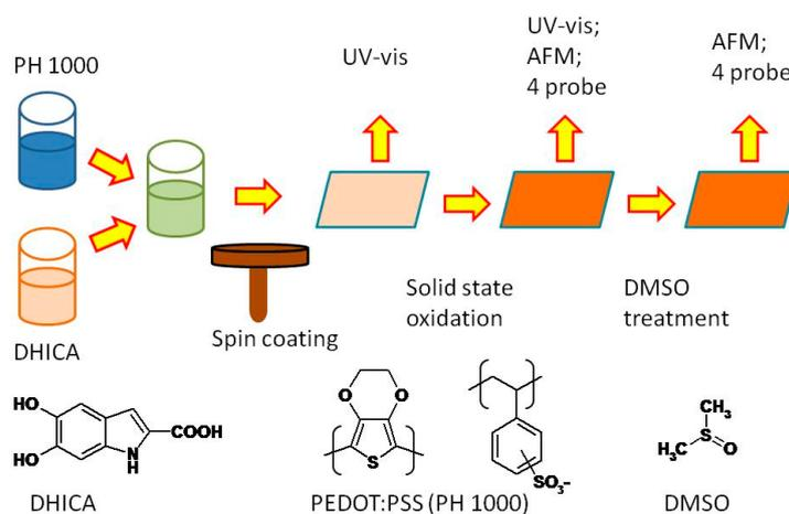
**Schema 1:** Step chiave della preparazione e della caratterizzazione del EuPH carbossilato (C-EuPH). AFM: microscopia di forza atomica; DHICA: 2-carbossi-5,6-diidrossindolo; PEDOT:PSS: poli(3,4-etilenediossiofene):poli(stirenesolfonato).
