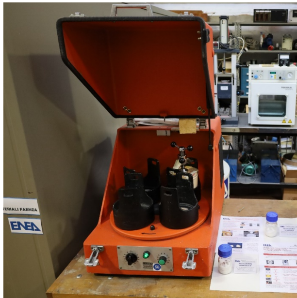
Figura 7. Planetary ball milling installato presso i Laboratori ENEA di Faenza
