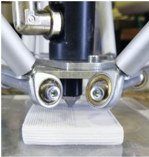
Figura 33. Immagini acquisite durante la stampa LDM della pasta di alluminio titanato
