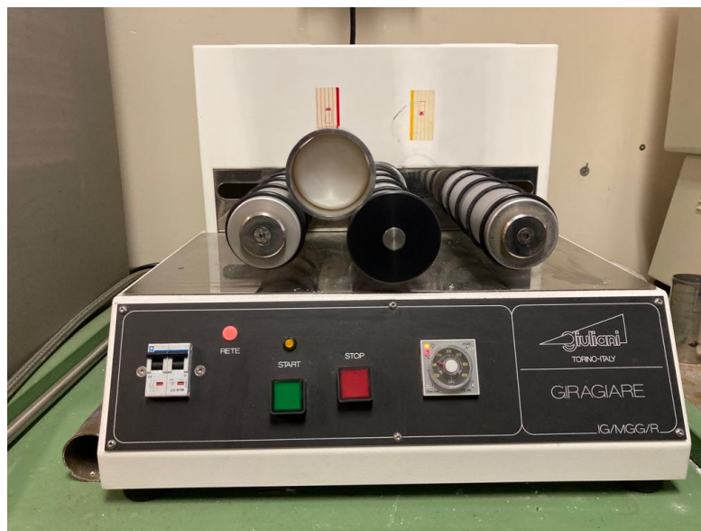
Figura 42. Apparato gira giare (Giuliani) utilizzato per la preparazione di miscele metallo/legante a differente composizione
