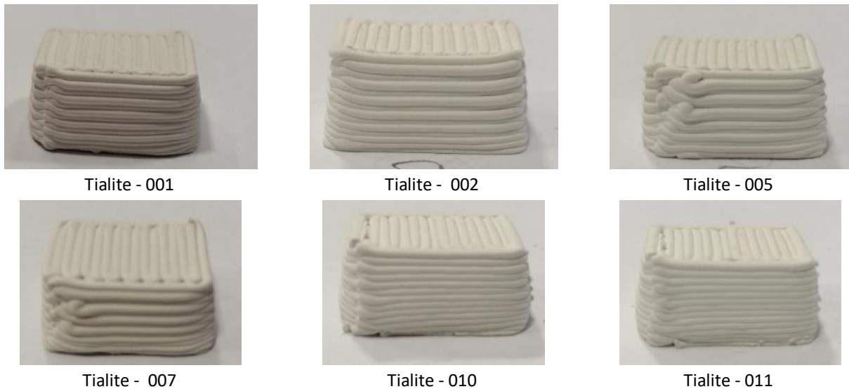
Figura 28. Campioni di alluminio titanato in verde da stampa 3D LDM (Output LA3.2)
