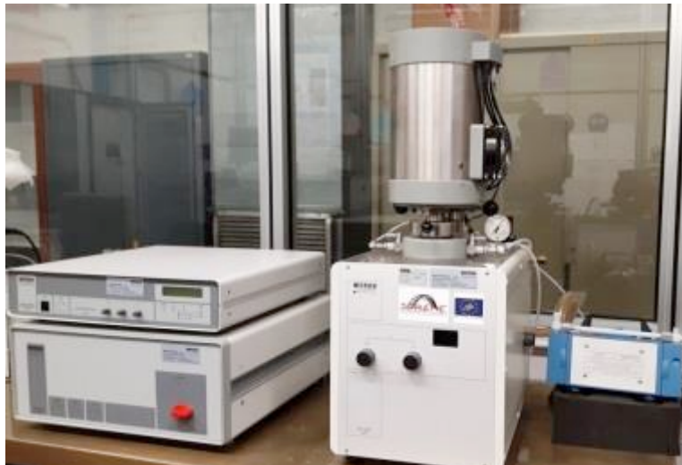
Figura 5. Termobilancia installata presso i Laboratori ENEA di Faenza
