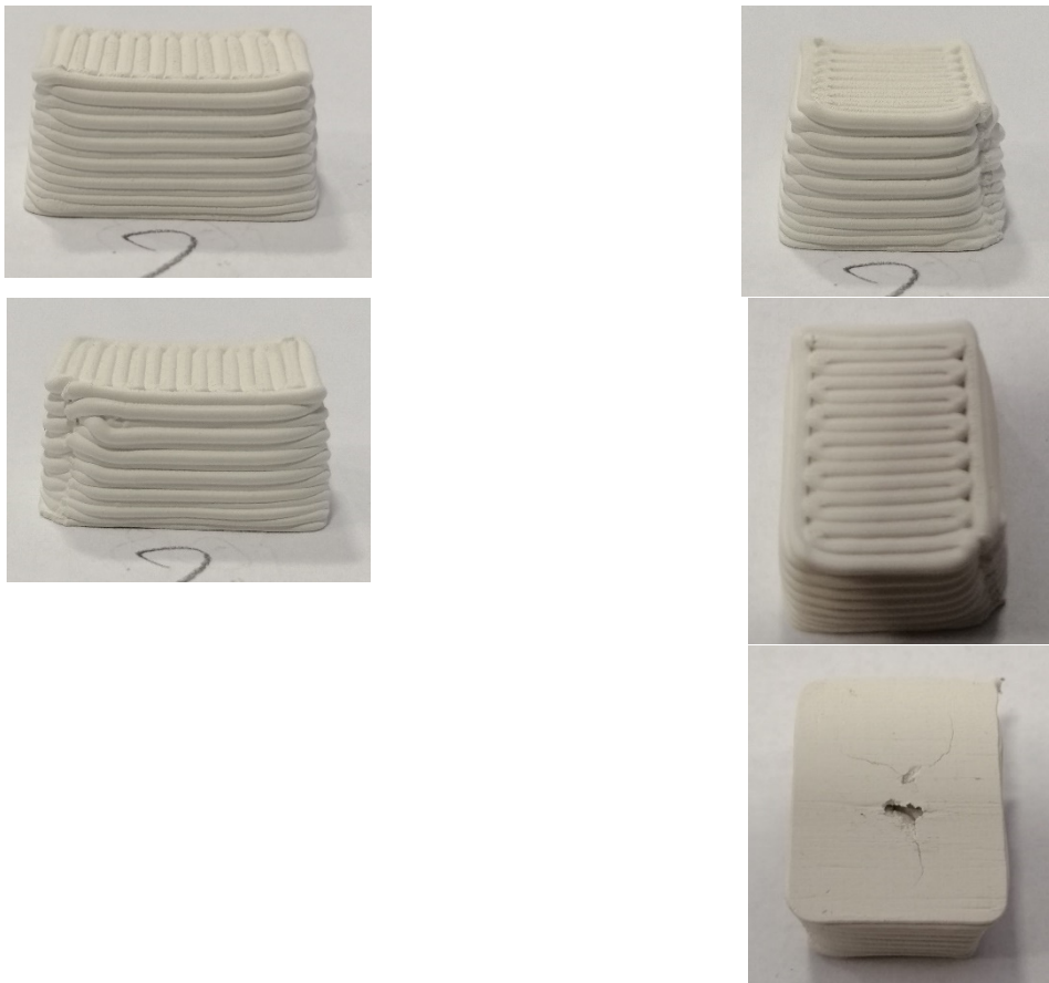
Figura 21. Immagini delle stampe 3D del G-code "002_4.3Block2151ONEwall07" con la pasta di alluminio titanato "HASE 2": campione "Tialite - 002"
