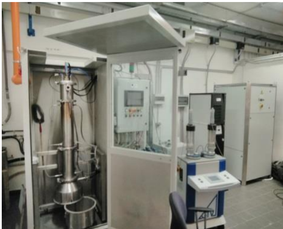
Figura 6. Impianto prototipo DC plasma installato presso CR ENEA Portici
