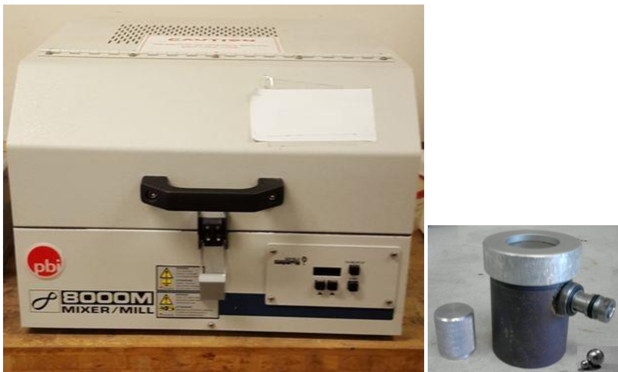
Figura 10: apparato e giare per la macinazione delle polveri (SPEX 8000)
