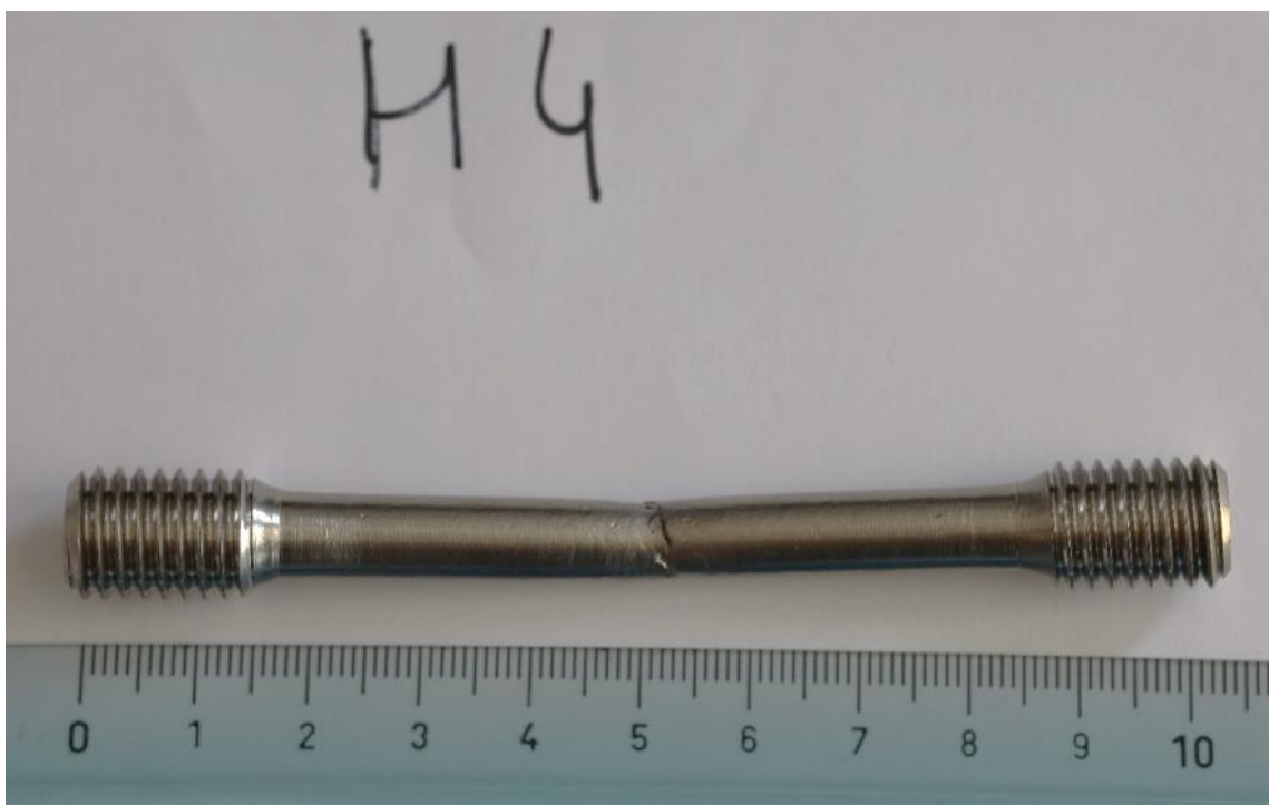
Figura 43s – Provino H4 dopo prova meccanica di trazione a T ambiente
