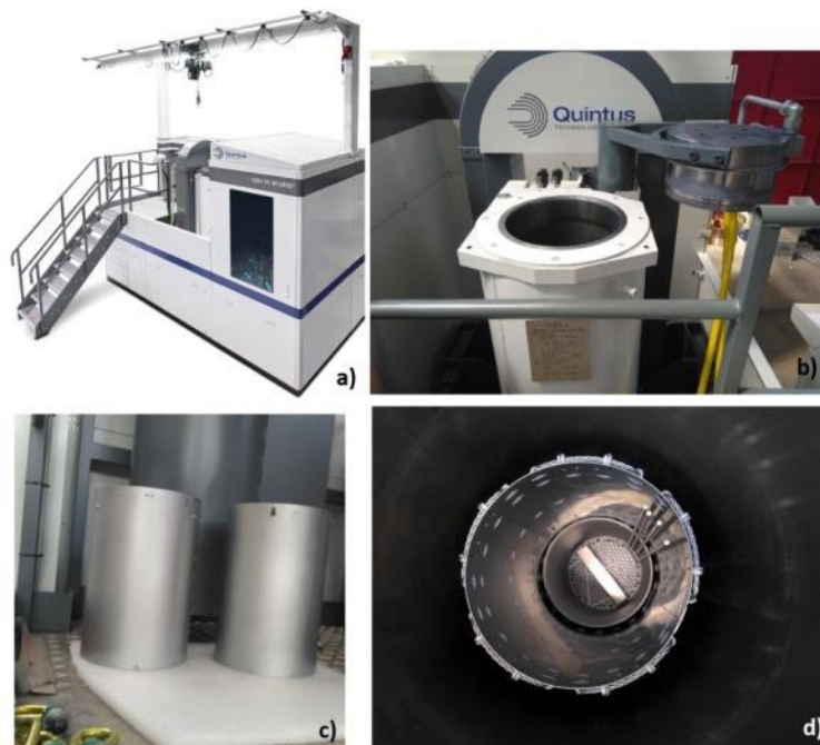
Figura 3: Immagine della pressa isostatica a caldo (HIP) QIH 21 M URQ della QUINTUS
