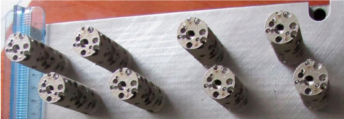
Figura 5. Campioni fabbricati attraverso processo additivo a letto di polvere con fascio laser.
