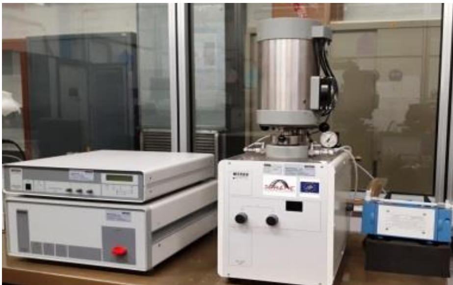
Figura 2. Analizzatore termico simultaneo STA 409C – Netzsch
