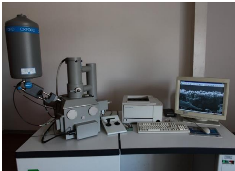
Figura 17. SEM-EDS (Microscopio a Scansione Elettronica LEO 438-VP)
