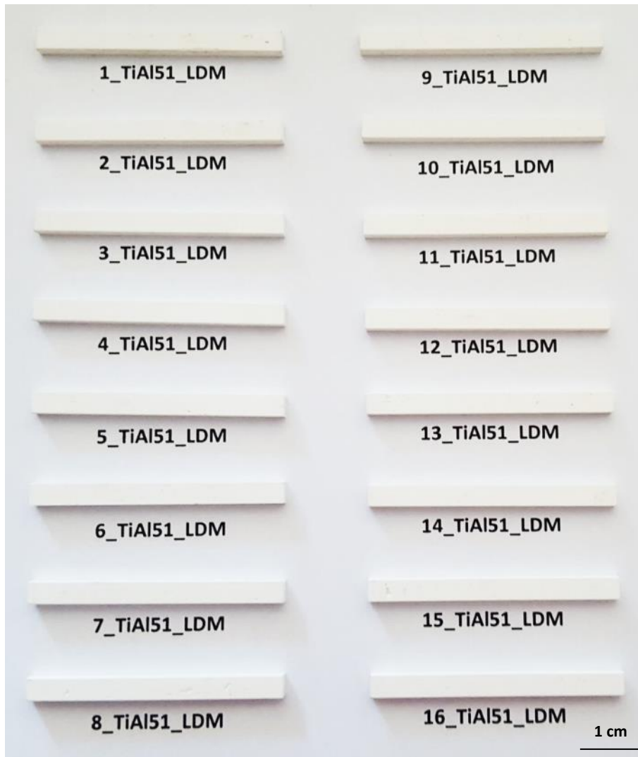
Figura 16. Provini di tialite sinterizzati per le caratterizzazioni del materiale da stampa 3D LDM
