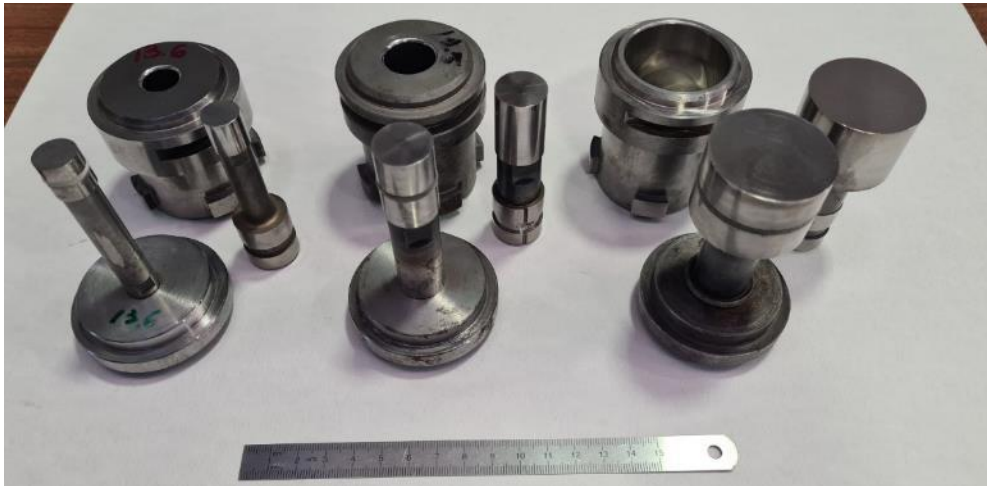
Figura 4. Stampi in acciaio inossidabile utilizzati per la formatura da pressatura assiale
