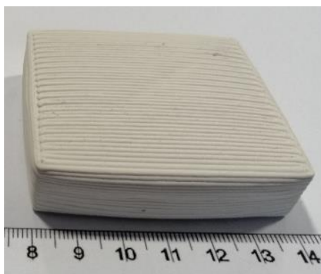
Figura 15. Piastra di tialite da stampa LDM e sinterizzata a 1500°C
