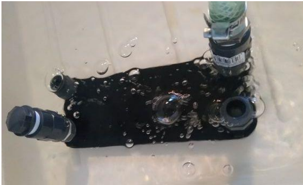
Figura 6: immagine dello scambiatore stampato mediante FDM durante il test di tenuta.
