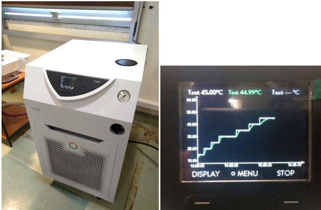
Figura 2: immagine del refrigeratore di circolazione con potenza di 4.5 kW in riscaldamento e 5 kW in raffreddamento
