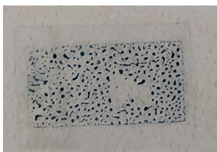
Fig. 3 - Immagini della stampa di PEDOT:PSS su substrato senza trattamento corona.
