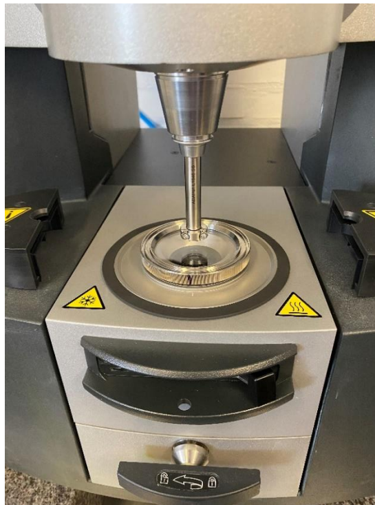
Figura 18. Particolare del kit con lampada UV-Vis, in cui si vede il piatto inferiore in quarzo e la geometria superiore.
