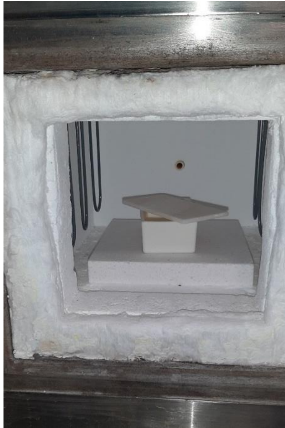
Figura 4. Modalità di utilizzo del crogiolo e del coperchio durante la sinterizzazione in aria
