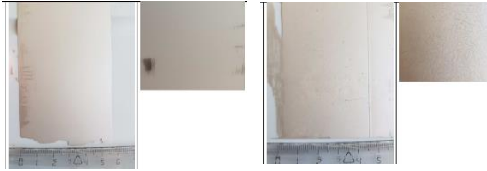
Figura.2. Risultato della deposizione di paste commerciali con tecnica Dr. Blade mediante sistema TCQ. Parametri di deposizione 10 mm/s e spessore 20 \mu\text{m}
