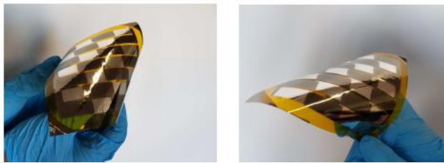
Figura.6. Il multistrato di partenza è ottenuto depositando per Dr. Blade uno strato di PDMS sulle 14 coppie Ag-Ni depositate su kapton. Se ne ottiene un foglio flessibile ed elastico su cui i materiali reggono senza screpolatura e con buona adesione.
