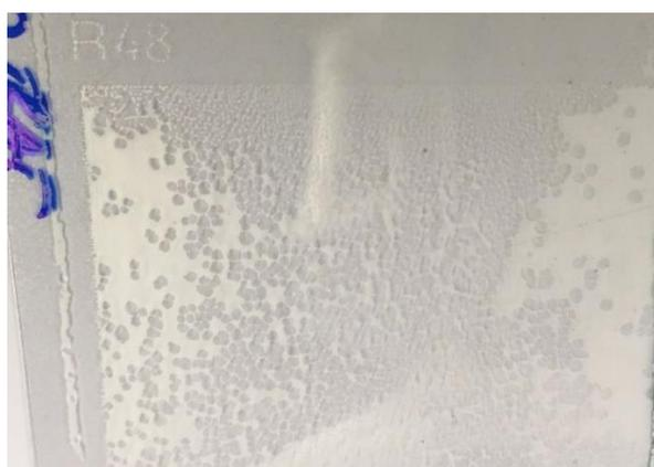
**Figura 3. Esempio di stampa rotocalco di PVDF su substrato di ITO-PET pre-trattato corona alla potenza di 50W.**
