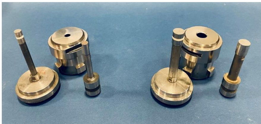
Figura 9. Stampi di diametro di 8.2 mm (a sinistra) e 13.6 mm (a destra) per la realizzazione dei componenti ceramici da inserire nei dispositivi piroelettrici prototipali
