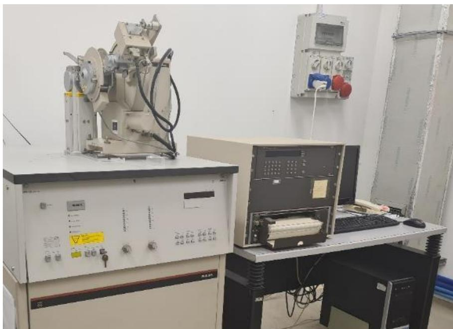
**Figura 5. Diffrattometro a raggi X installato presso i Laboratori ENEA di Faenza**
