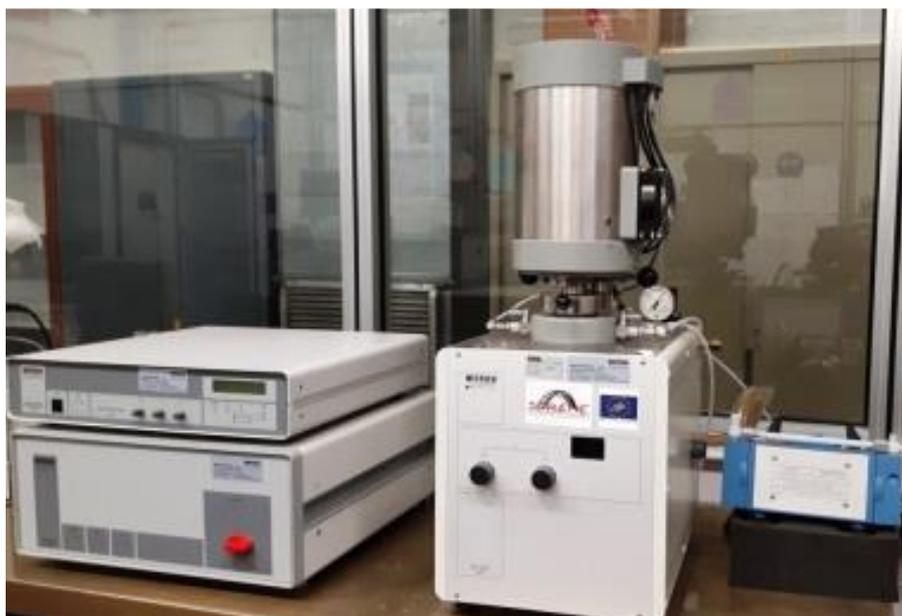
**Figura 3. Termobilancia installata presso i Laboratori ENEA di Faenza**
