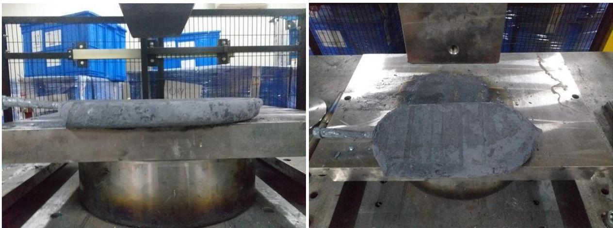
Figura 4: immagine della barra dopo la pressatura
