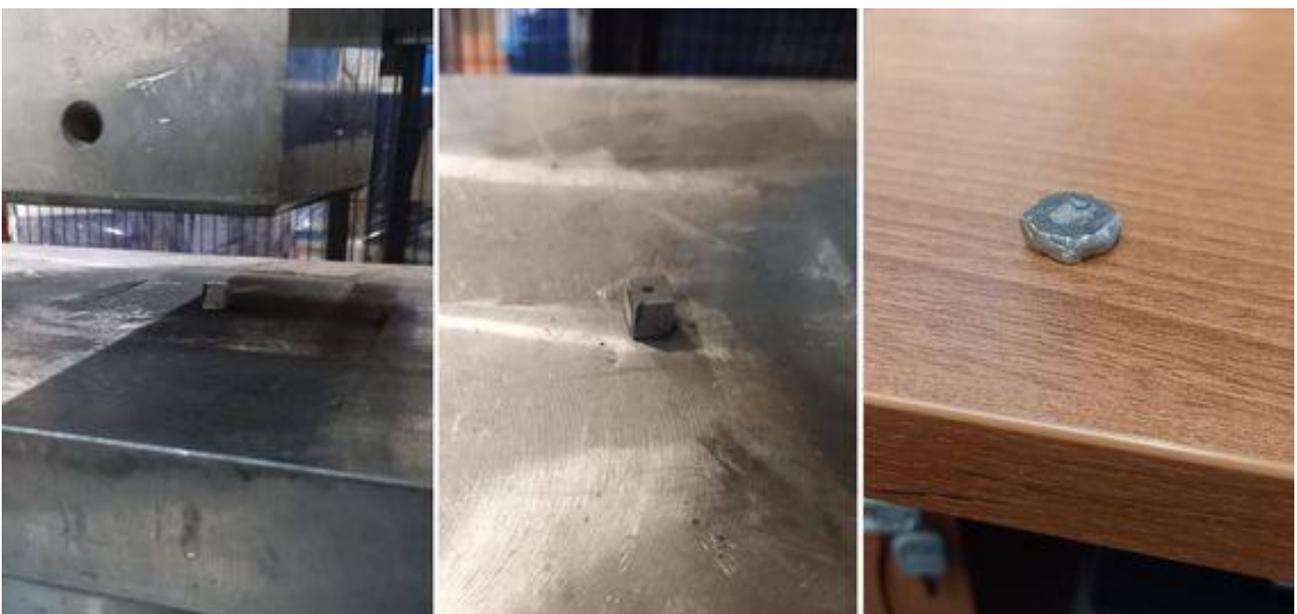
**Figura 19: campione cubico per pressatura a freddo**
