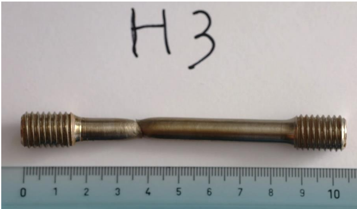
Figura 28. Provino H3 dopo prova meccanica di trazione a 400°C
