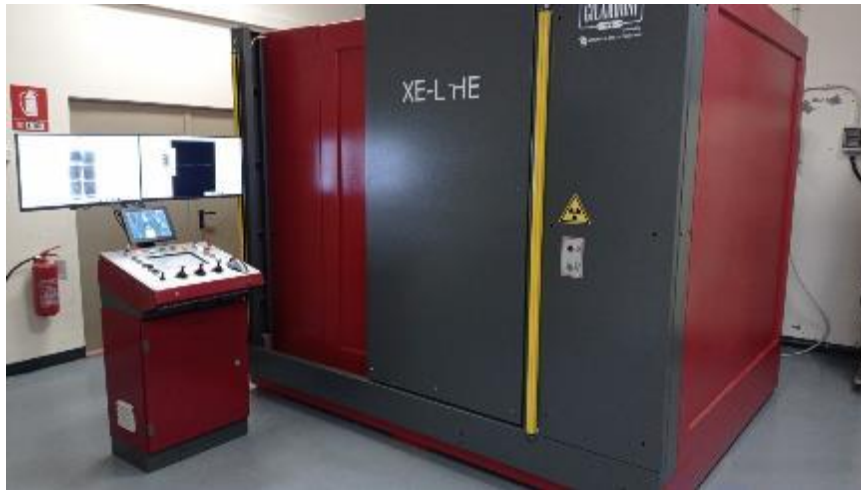
Figura 6. Cabina tomografica della macchina Gilardoni installata presso il C.R. Casaccia
