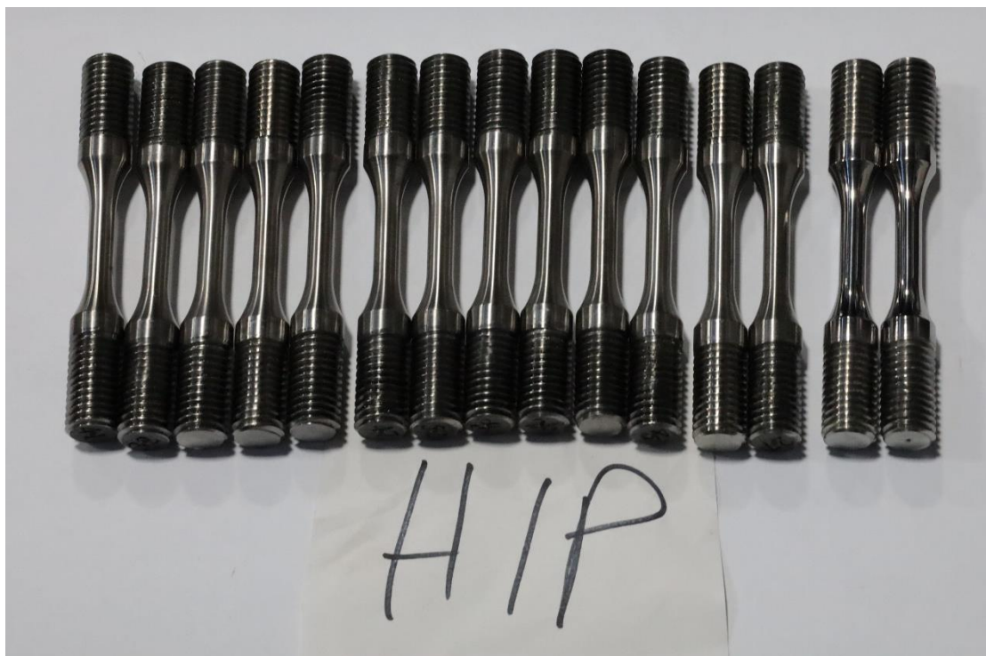
Figura 32 –Provini hippati per prove di LCF; quelli non hippati in foto appaiono identici
