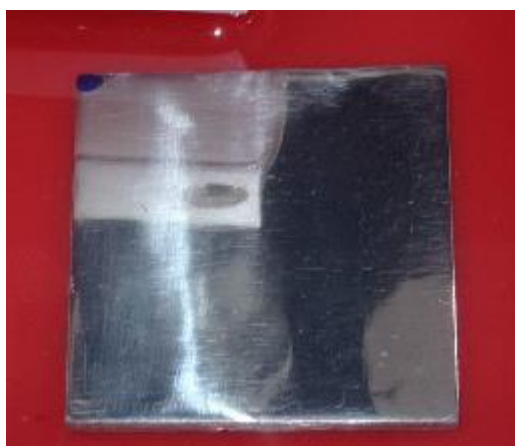
Figura 11 Foto del campione usato per le prove preliminari. Il segno nero è il riferimento e lo zero macchina
