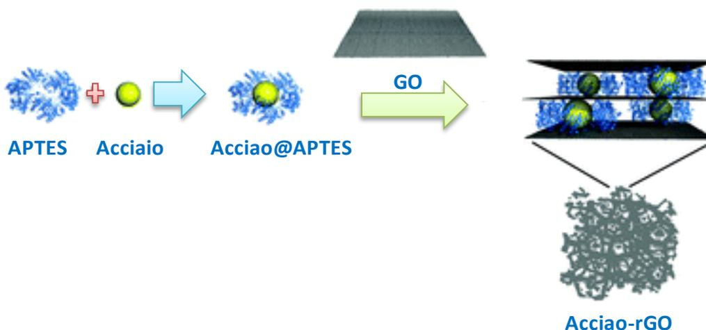
Figura 11. Schema per ricoprimento di ossido di grafene su particelle di acciaio
