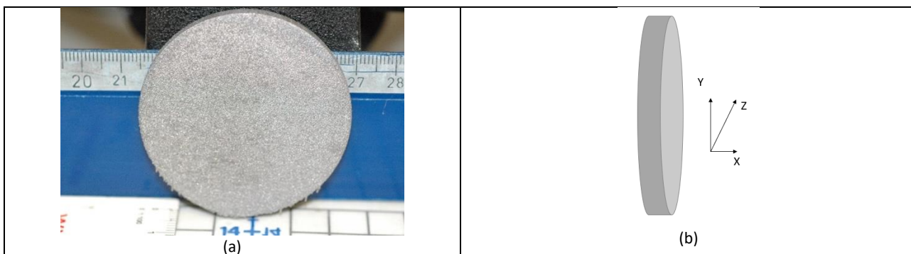
Figura 2: (a) immagine rappresentativa dei dischi in lega di alluminio A357 prodotti tramite LPBF ed utilizzati nelle prove tribologiche di strisciamento reciprocante non lubrificato ball-on-disk ; (b) schema delle orientazioni microstrutturali prese in esame durante la caratterizzazione pre-prove tribologiche dei dischi stazionari A357 LPBF. La superficie impiegata per le prove tribologiche corrisponde al piano YZ.
