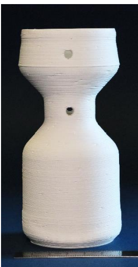
Figura 83. Gassificatore ceramico prima della sinterizzazione, ottenuto da stampa 3D con la pasta di tialite Zircomet sviluppata da ENEA
