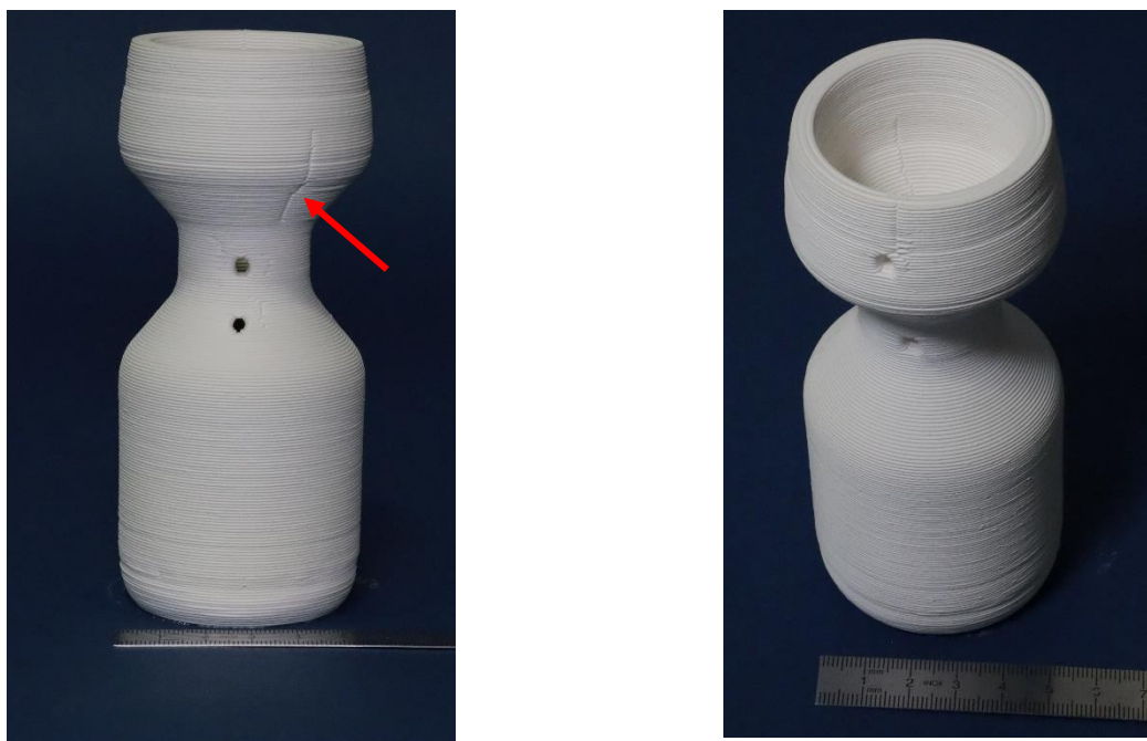
Figura 77. Simulacro del gassificatore stampato 3D con materiale convenzionale porcellana dopo cottura e realizzato per la verifica delle impostazioni di stampa
