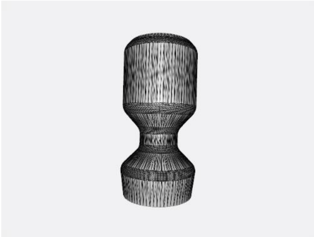
Figura 54. File STL del componente dimostrativo ceramico (gassificatore)
