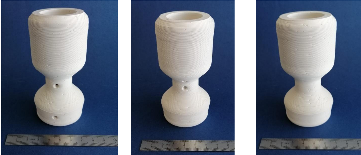
Figura 86. Gassificatore ceramico dopo sinterizzazione a 1500°C, ottenuto da stampa 3D con la pasta di tialite Zircomet sviluppata da ENEA
