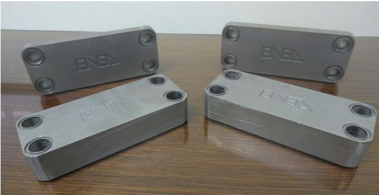
Figura 21: immagine degli scambiatori realizzati mediante DMLS.
