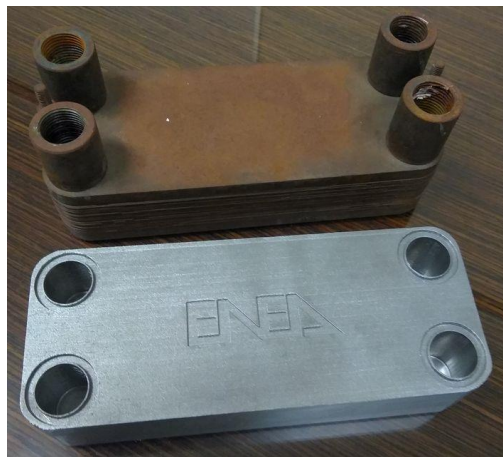
Figura 27: immagine degli scambiatori di calore realizzati da ENEA nella versione originaria, realizzato mediante saldobrasatura, sia in quella odierna, ottenuto mediante stampa 3D.
