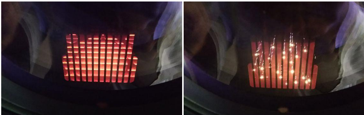
Figura 10: immagini della fase di preriscaldamento (sinistra) e di fusione (destra) della polvere rispettivamente durante un processo EBM.
