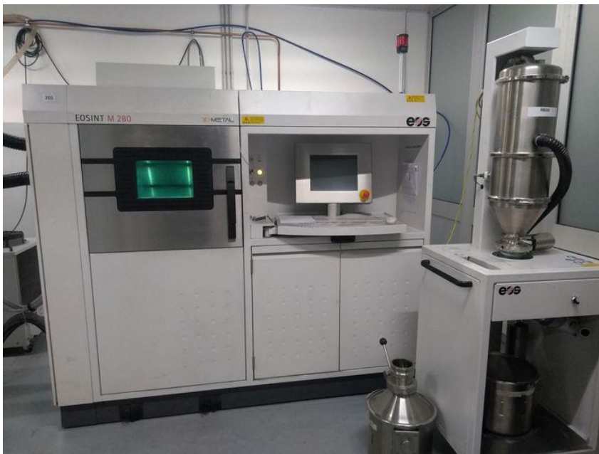
Figura 18: stampante laser DMLS EOS M280 con la quale sono stati scambiati gli scambiatori di calore
