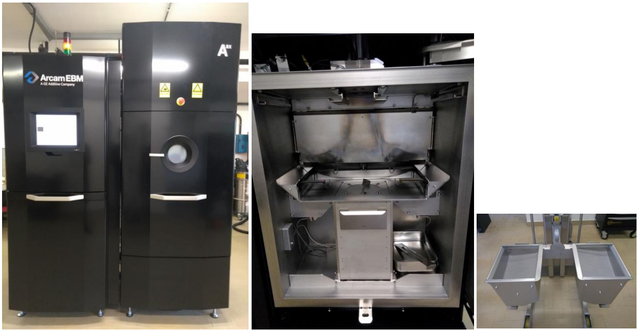
Figura 9: Immagine dell'EBM Arcam A2X della GE utilizzata per le prove di stampa (sinistra), particolare della camera interna e tramogge di carico della polvere (destra).
