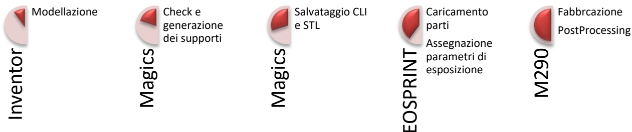
Figura 102 Workflow della produzione delle palette
