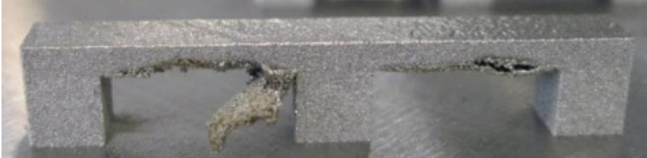
Figura 17 Effetto della mancanza delle strutture di supporto per superfici completamente aggettanti
