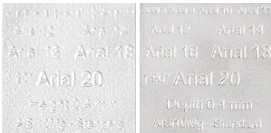
Figura 69 Scritta in altorilievo (sinistra) e bassorilievo (destra) su un componente in AISi10Mg
