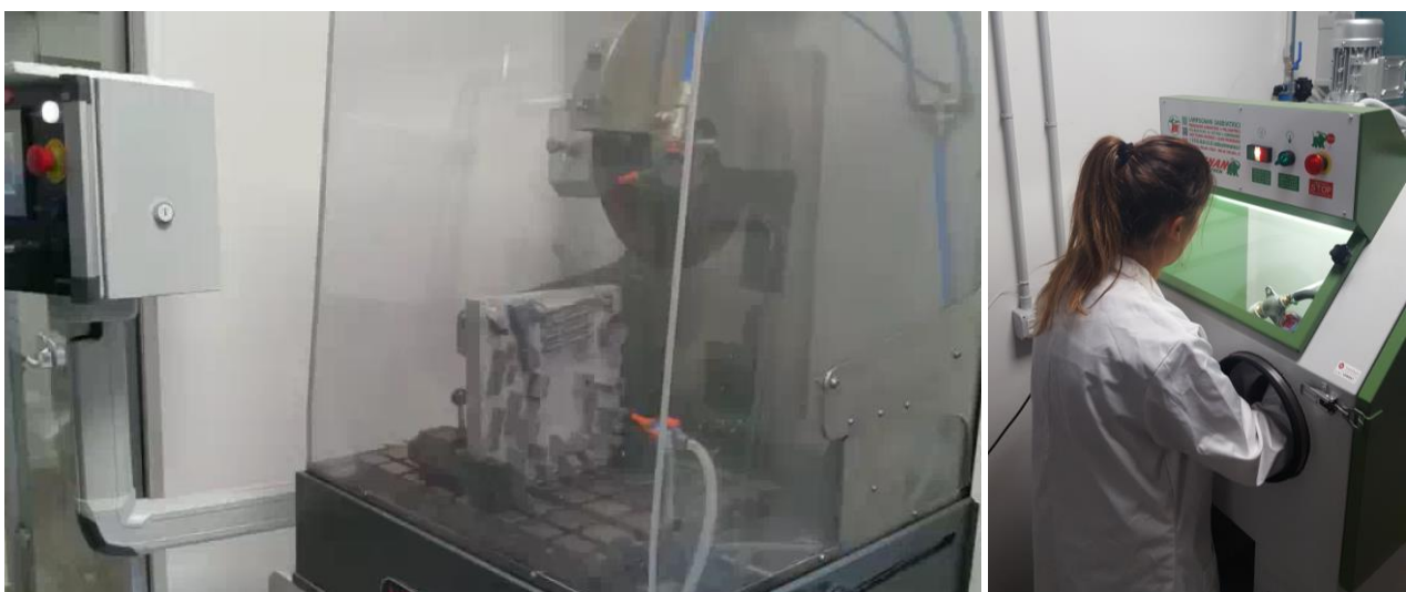
Figura 113 Troncatura a controllo (sinistra) e sabbatura (destra)
