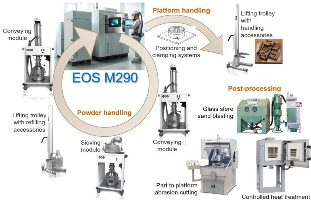
Figura 108 Workflow delle operazioni in macchina
