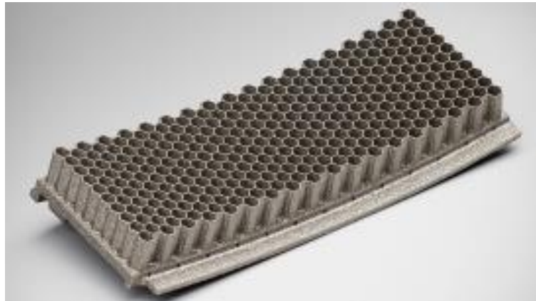
Figura 11 Stato di deformazione indotto in un pannello a cella esagonale evidenziato dopo il distacco dalla tavola di fabbricazione
