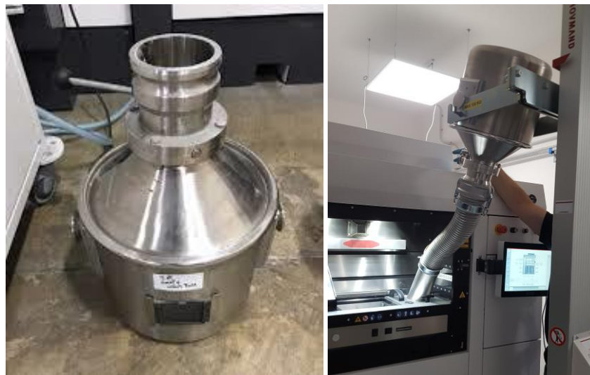
Figura 109 Bin per la movimentazione delle polveri (sinistra) e fase di caricamento in macchina (destra)
