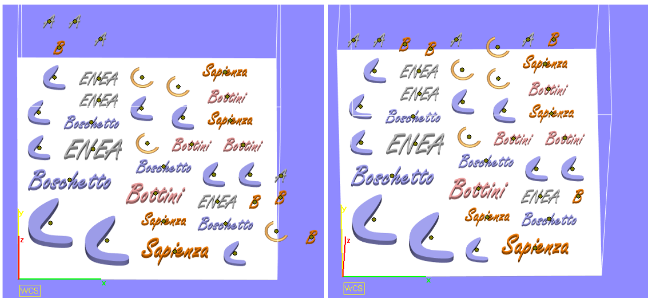
Figura 3 Soluzioni per algoritmi a riquadro delimitatore: prima soluzione possibile (sinistra) e area superficie minima (destra)
