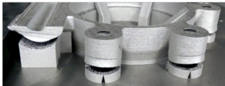
Figura 13 Distacco delle strutture di supporto nella zona da sostenere
