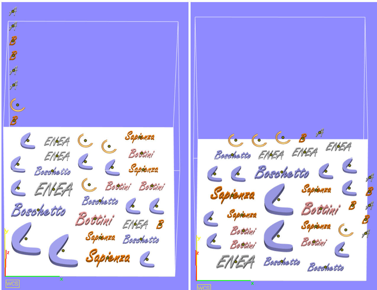
Figura 4 Soluzioni per algoritmi a riquadro delimitatore: dimensione X minima (sinistra) e centro piattaforma (destra)
