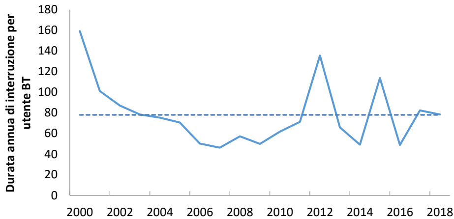
Figura 18. Durata annua di interruzioni lunghe senza preavviso per utente BT: valore medio per il centro Italia.
