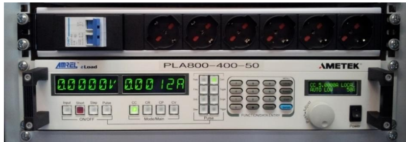
Figura 60: Carico elettronico e particolare delle prese di servizio
