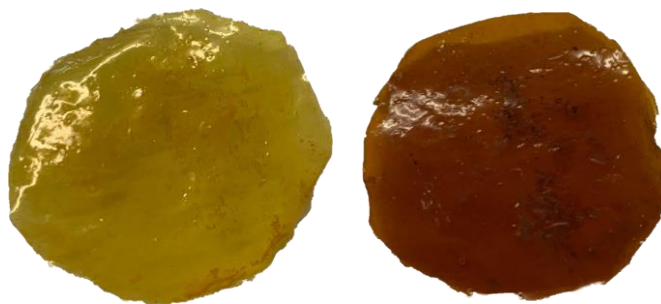
Figura 19. Membrana di Celgard reticolata con PKIm (sinistra) e dopo quaternizzazione (destra) con ioduro di etile.
