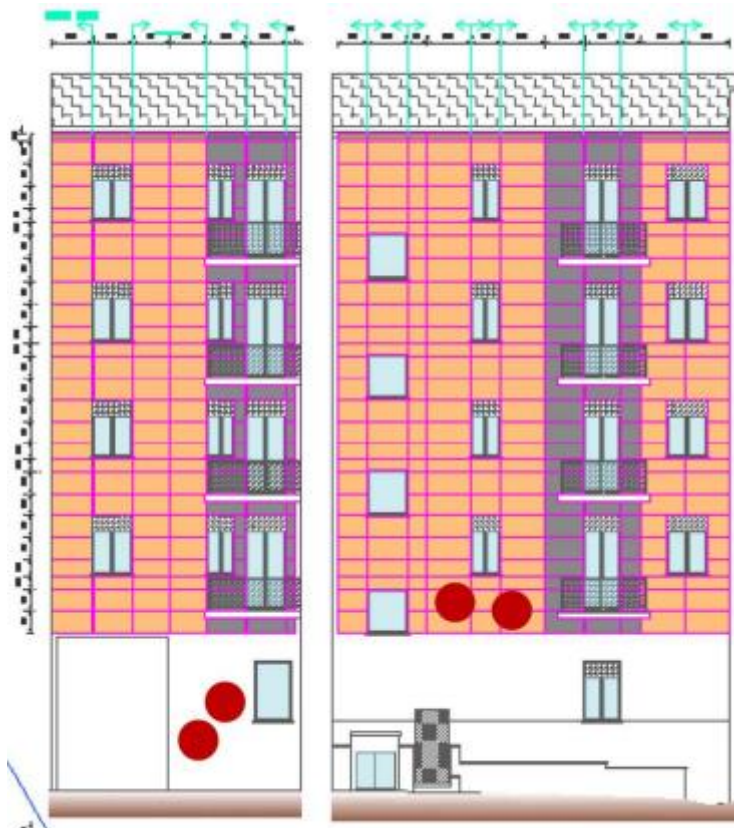
Figura 46: indicazione dei punti sui quali sono state effettuate le verifiche di fissaggio
