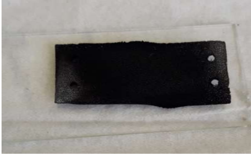
Figura 11. Fotografia di un elettrodo auto-supportato in CNW, dopo la separazione dal substrato di schiuma di nichel. Per le dimensioni, il vetrino portaoggetti è da 26x76mm 2 .
