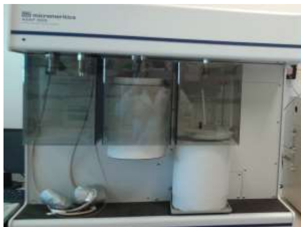
Figura 5: strumento per analisi BET e BJH della Micromeritics modello ASAP 2020.
