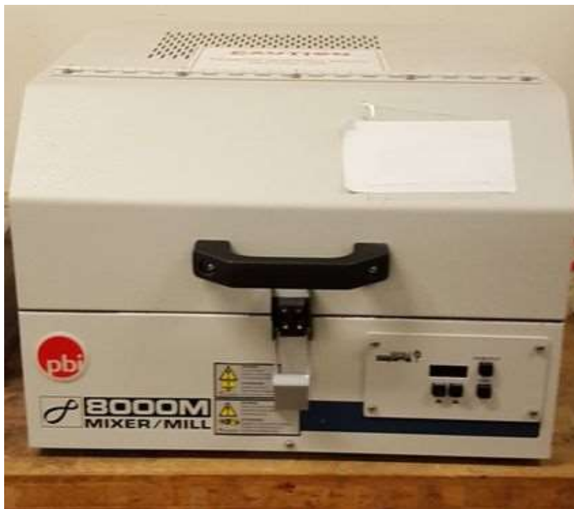
Figura 1: apparato di macinazione delle polveri (SPEX 8000).
