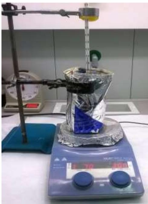
Figura 14. Reattore in vetro (in scala di laboratorio) utilizzato per il processo di sintesi “one-pot”.
