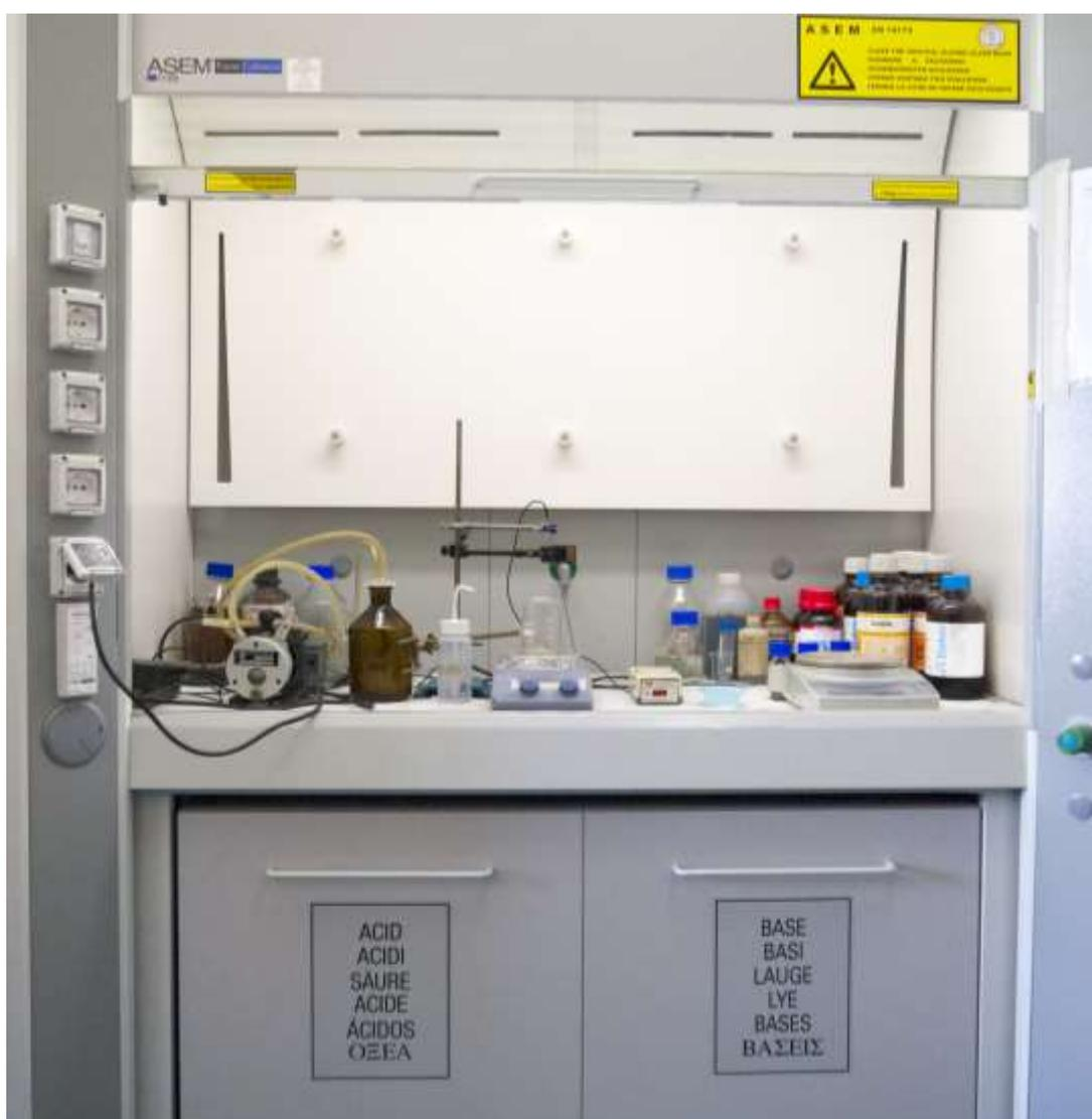
Figura 1. Immagine della cappa ad aspirazione utilizzata per il processo di sintesi dei liquidi ionici.
