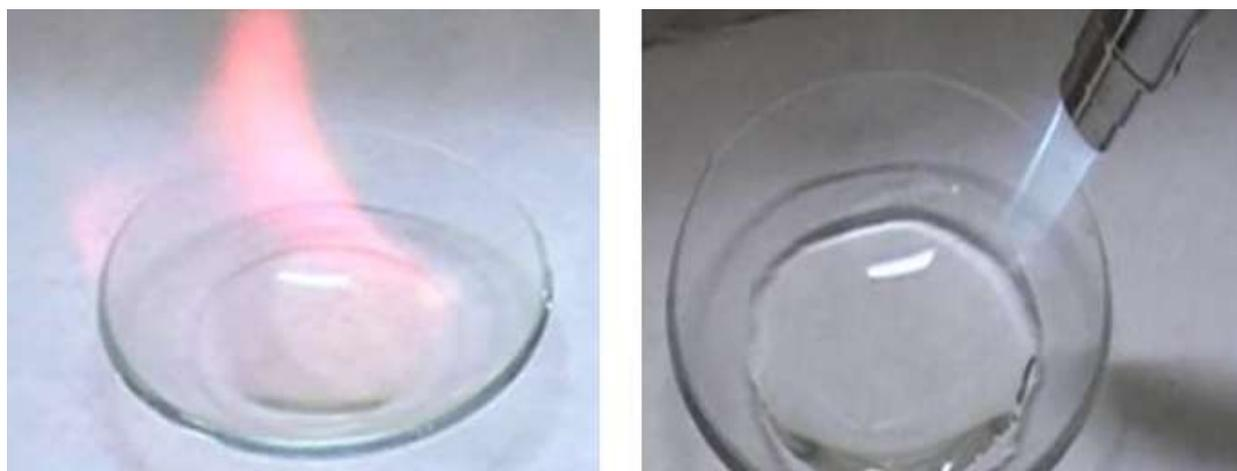
**Figura 8. Test di ignizione eseguiti su solventi organici convenzionali (pannello sinistra) e sul liquido ionico PIP<sub>13</sub>TFSI (pannello destra).**
