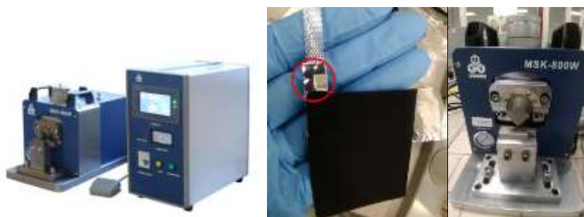
Figura 34: Saldatrice ad ultrasuoni marca MTI modello MSK-800W e particolare della saldatura e della testa saldante.
