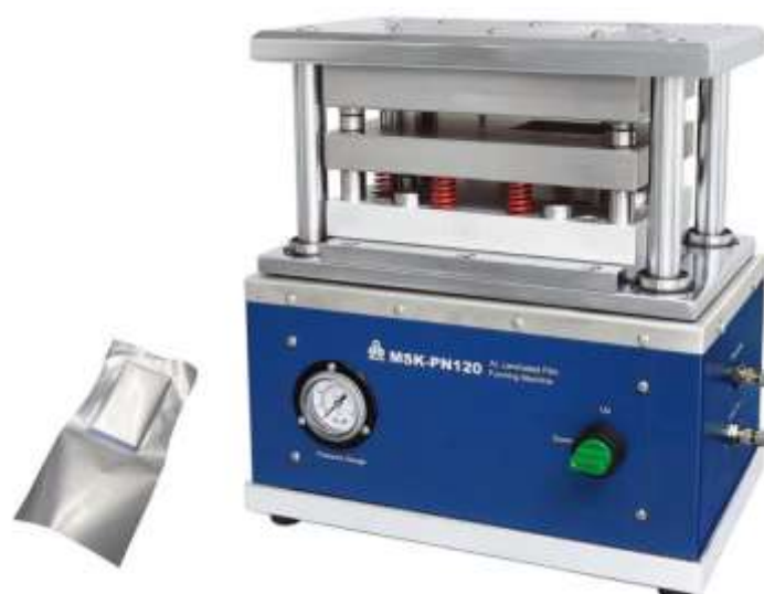
Figura 35: Imbutitrice marca MTI modello MSK-Pn-120. A sinistra particolare del foglio di poliaccoppiato dopo imbutitura.
