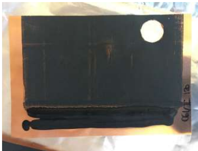
Figura 24: anodo realizzato secondo la ricetta riportata in tabella 12 su rame liscio.
