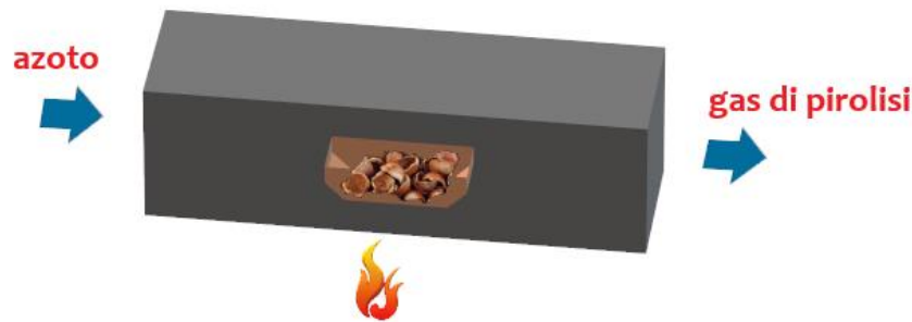
Figura 4. Schema del forno di carbonizzazione.
