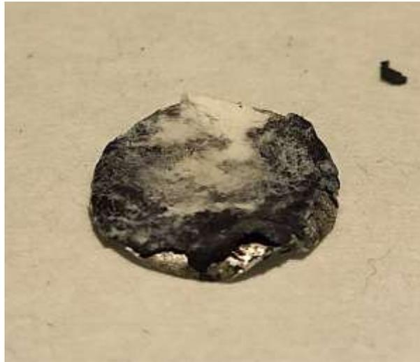
Figura 12. Immagine dell'elettrodo dopo i ripetuti cicli di carica/scarica.
