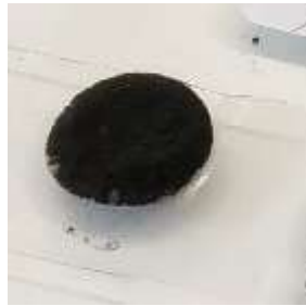
Fig.13. Elettrodo di nickel foam dopo il coating di ACT con pullulano come legante.
