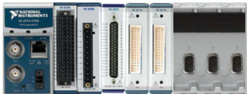
**Figura 16: Sistema di acquisizione dati**
