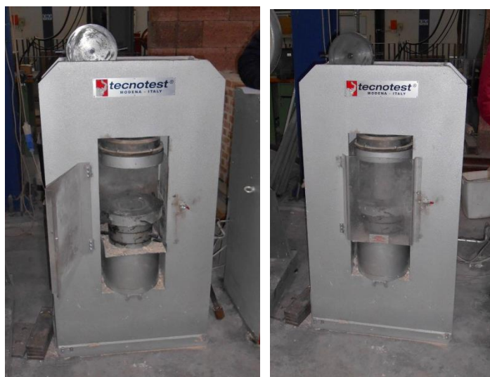
Figura 25- Macchina di compressione Tecnotest serie KE con carico massimo 1000kN vuota (a sinistra) e con un provino alto inserito (a destra).
