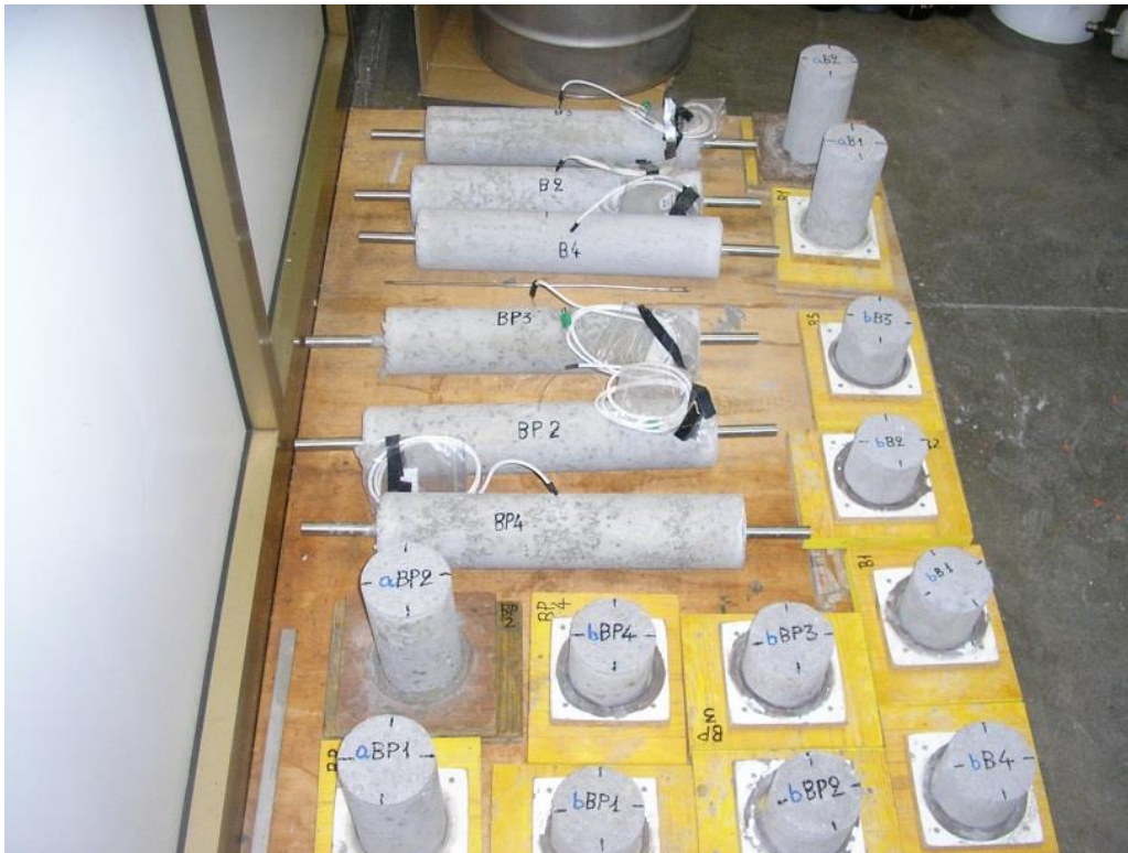
Figura 8- I provini identificati, liberati dai casseri e pronti per la caratterizzazione.
