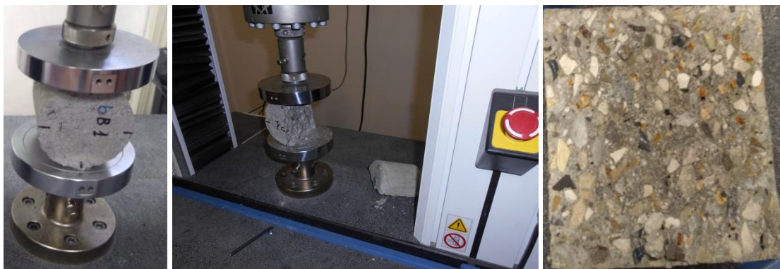
Figura 28- Provino montato prima della prova e provino danneggiato a fine prova
