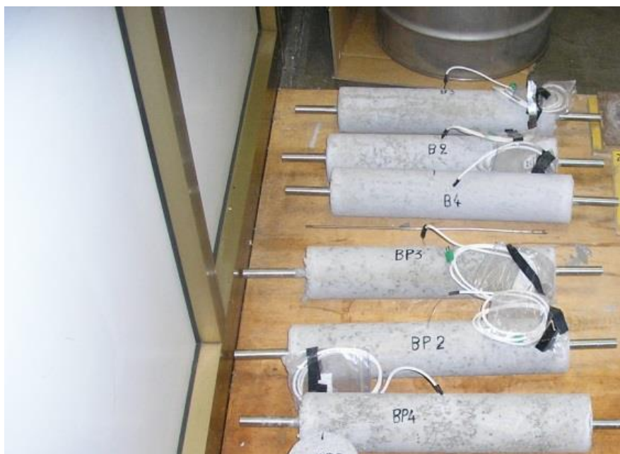
Figura 1- Provini identificati, liberati dai casseri e pronti per la caratterizzazione.
