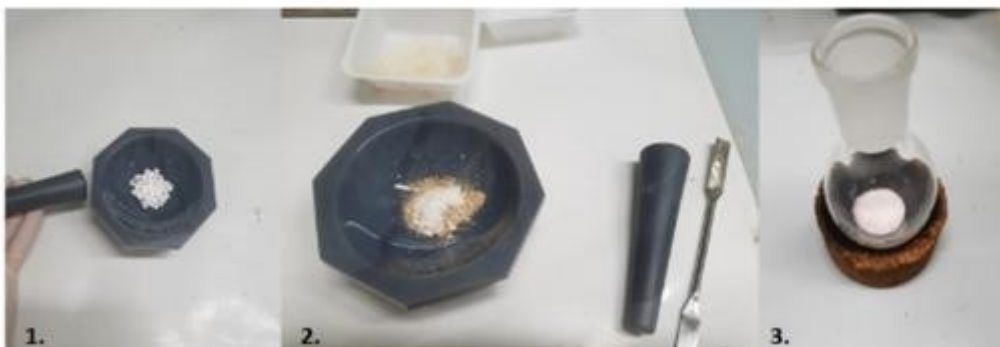
Figura 21. Preparazione dei campioni: 1) \gamma -allumina pellets, 2) materiale polverizzato e setacciato e 3) polvere prima di essere inserita nel Rotavapor.
