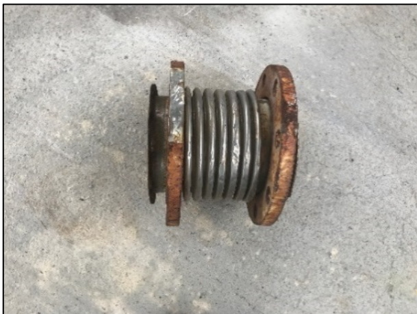
Figura 4.53 – Giunto di dilatazione DE002.
