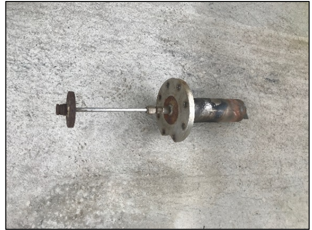
Figura 4.15 - Dispositivo rompiponte inferiore.
