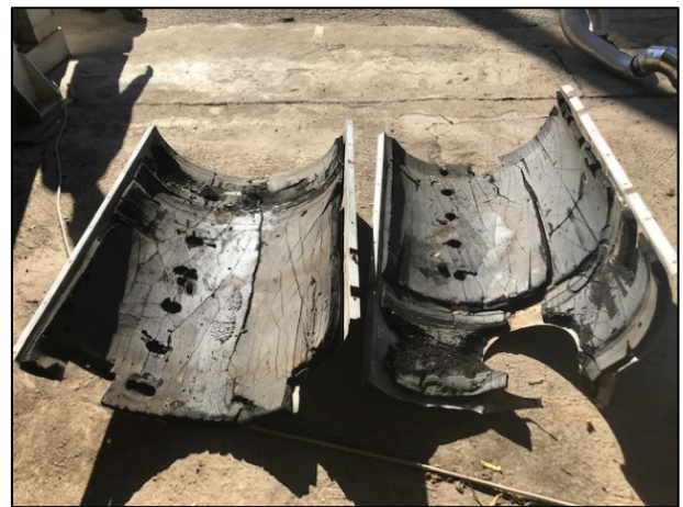
Figura 4.13 – Coibentazione rimossa dal reattore.
