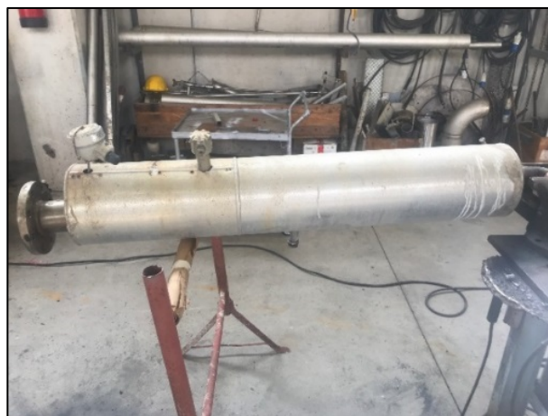
Figura 4.38 – Tubazione di alimentazione agenti gassificanti in officina per le modifiche.
