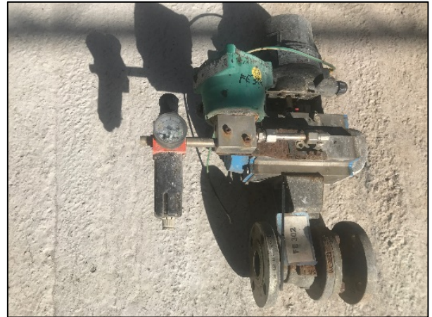
Figura 4.24 - Valvola di intercettazione pneumatica FE302 dopo la rimozione.
