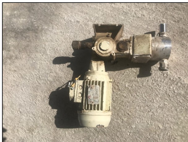
Figura 4.36 – Pompa dosatrice CF003 dopo lo smontaggio
